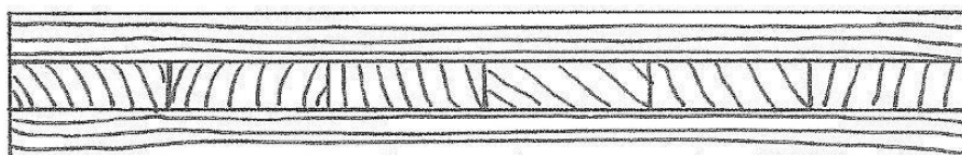
Schematischer Aufbau der Dreischichtplatten HPA 3-S mit "Stehender Lage" als Mittellage
