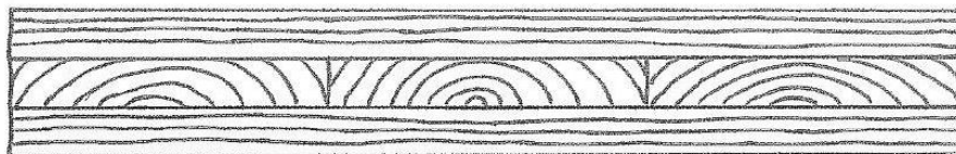
Schematischer Aufbau der Dreischichtplatten HPA 3-S mit Brettlagen
