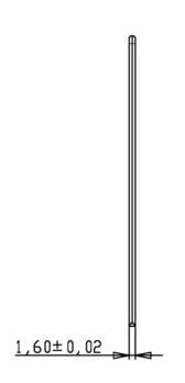
Klammerrohdraht: nichtrostender runder Stahldraht ø 1,53±0,03mm Zugfestigkeit ≥ 900 N/mm² Harzung  $L_H = mind. \ 0.5 \ L_n \ ; \ge 20mm$  WNr. 1.4301 / 1.4401 oder 1.4529 Schaftlänge  $L_n = 25.0 - 100.0mm$
