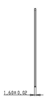
Klammerrohdraht: verzinkter runder Stahldraht ø 1,53 $\pm$ 0,03mm Zugfestigkeit  $\geq$  900 N/mm<sup>2</sup>
