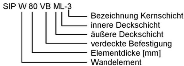
Sandwichelemente "SIP" nach EN 14509 mit Stahldeckschichten und einem Kernwerkstoff aus Polyurethan-Hartschaum;
