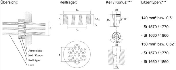
Keilsätze für die Verankerung der 140 mm² Litzen (d=0,6") tragen an der Oberseite den Aufdruck 0,6. Keilsätze für die Verankerung der 150 mm² Litzen (d=0,62") tragen an der Oberseite den Aufdruck 0,62.
