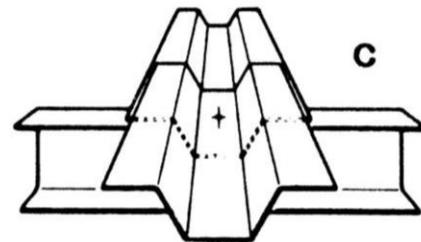
Verbindung mit einem Längs- und Querstoß
