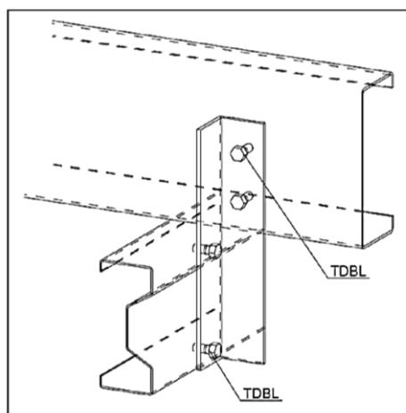
Verbindungselemente zur Verbindung von Bauteilen aus Stahl im
