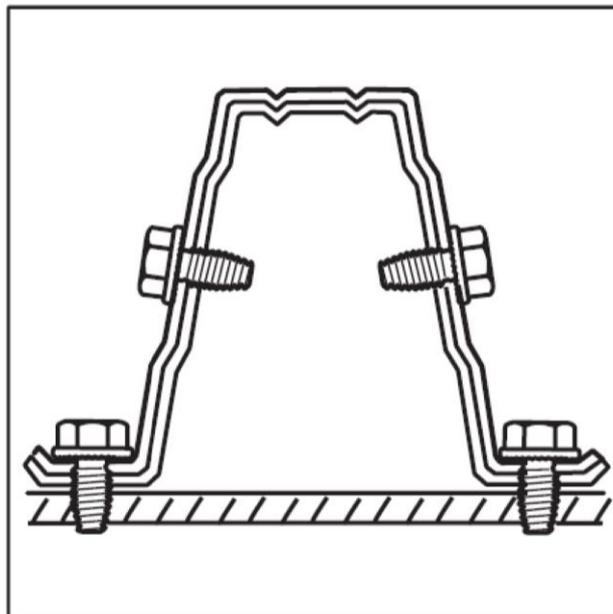
**Verbindungselemente zur Verbindung von Bauteilen aus Stahl im Hochregallagerbau und Stahlbau**
