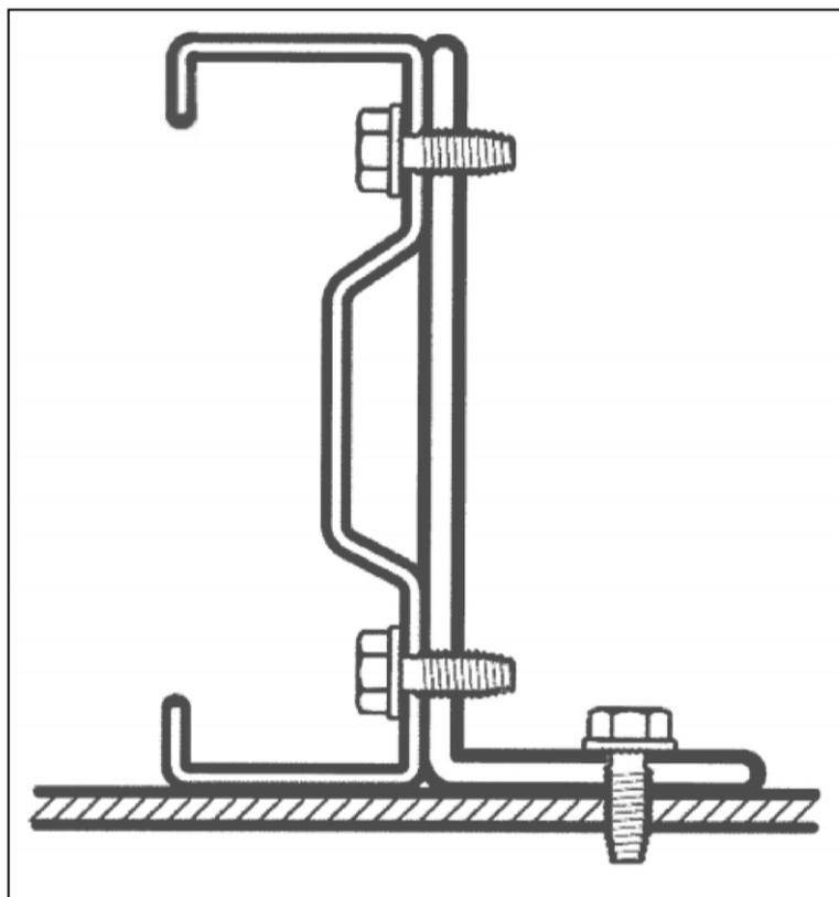
**Verbindungselemente zur Verbindung von Bauteilen aus Stahl im Hochregallagerbau und Stahlbau**
