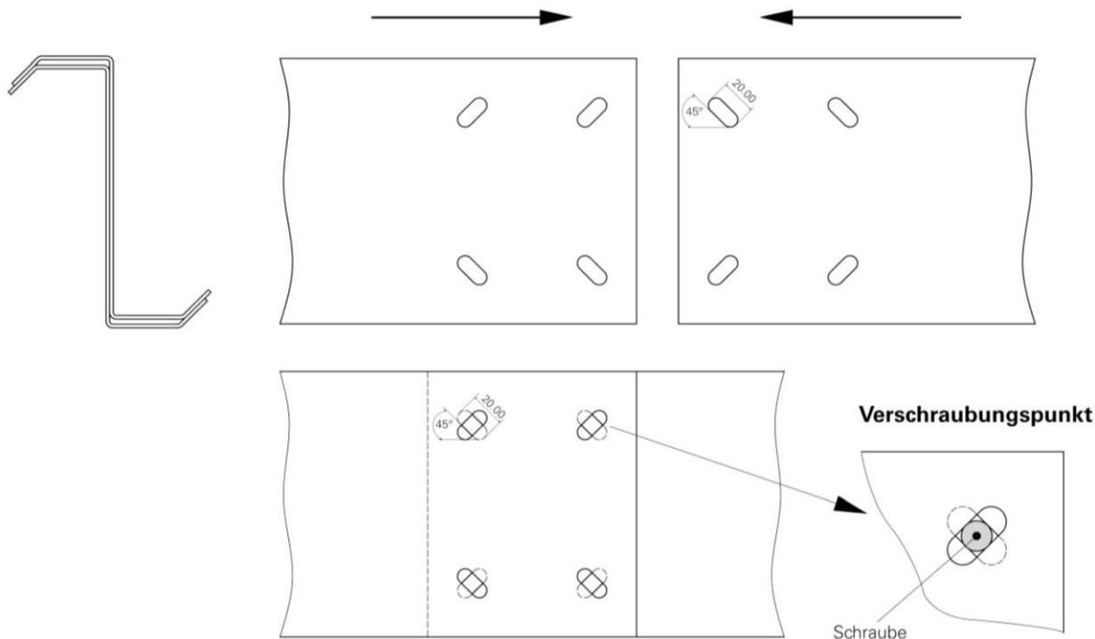
Verbindungselemente zur Verbindung von Bauteilen aus Stahl im
