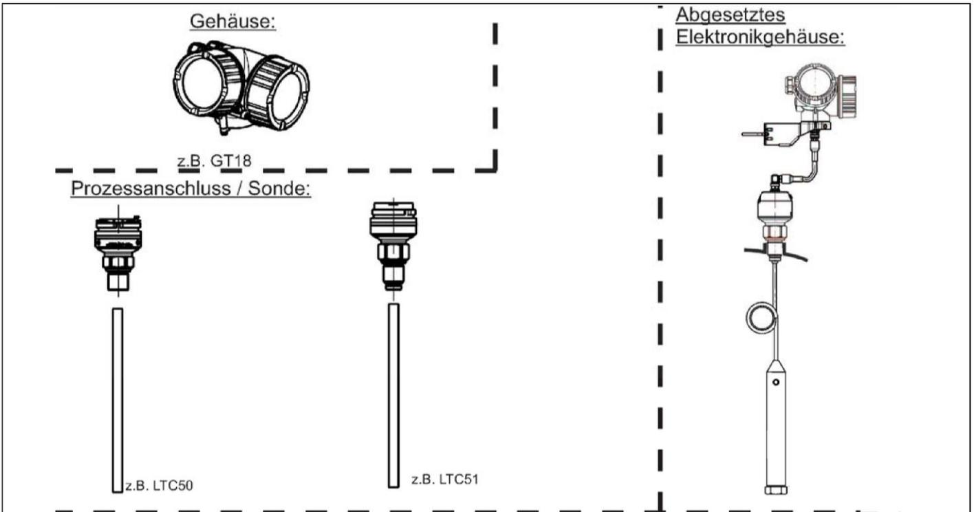
Schema der Überfüllsicherung
