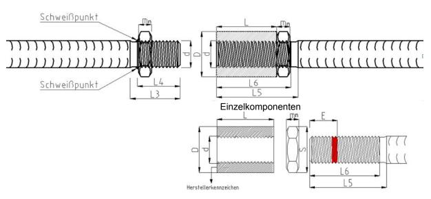
Betonierabschnitt, Gewindestab für Positionsverbindung, Mutter fixiert
