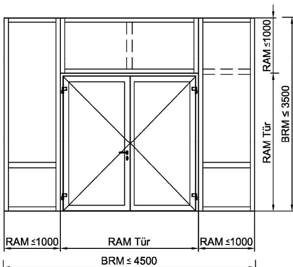
**Das Seitenteil darf nur U-förmig an die T90-1-Tür bzw. T90-2-Tür gekoppelt werden, wenn die Tür kein Oberteil besitzt.**
