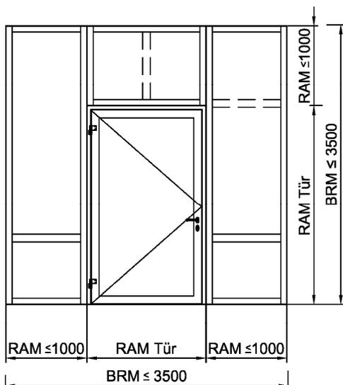
**Das Seitenteil darf nur U-förmig an die T90-1-Tür bzw. T90-2-Tür gekoppelt werden, wenn die Tür kein Oberteil besitzt.**
