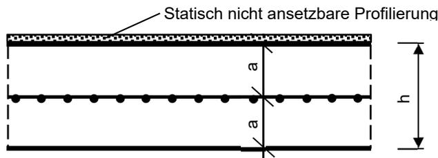
Querschnitt der Fassadenplatte: Dicke h und Lage der Bewehrungsmatte
