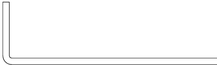
▲ Wandanschluss-Befestigungswinkel, Variante 1 ZSR2150, Abm. 29x100x3
