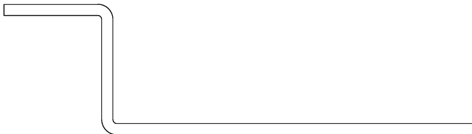
▲ Wandanschluss-Befestigungswinkel, Variante 2 ZSR2150, Abm. 29x35x100x3
