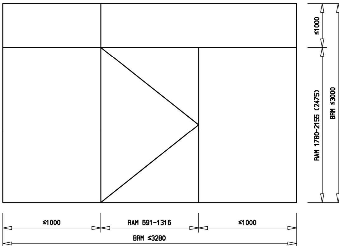
(...) Werte in Klammern gelten für Feuerschutzabschlüsse mit oberer Türverriegelung
