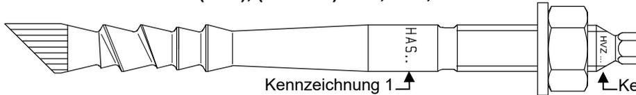
Kennzeichnung 1: Ankerstangen-Typ, Größe und Anbauteildicke; z.B., HAS-TZ M12/50
