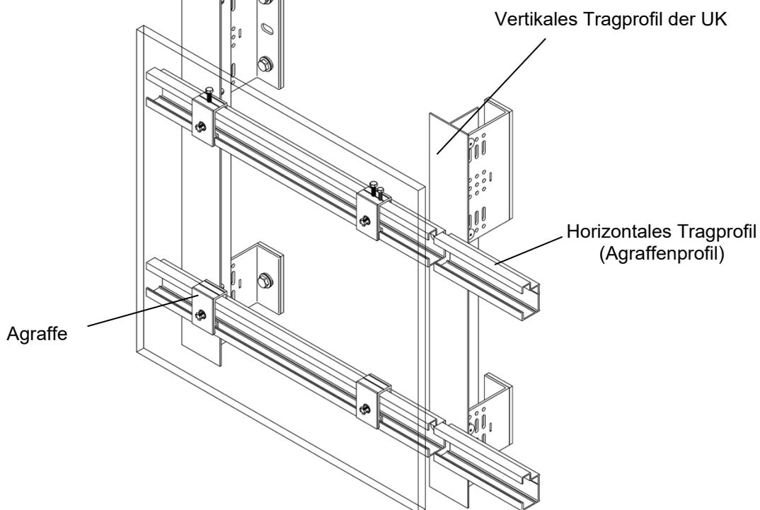
KEIL Hinterschnittanker KH für Feinsteinzeug - Fassadenplatten
