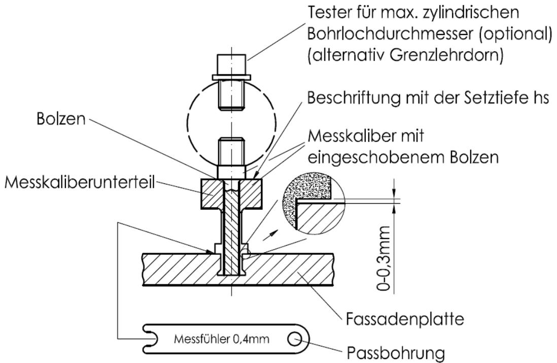
KEIL Hinterschnittanker KH für Feinsteinzeug - Fassadenplatten
