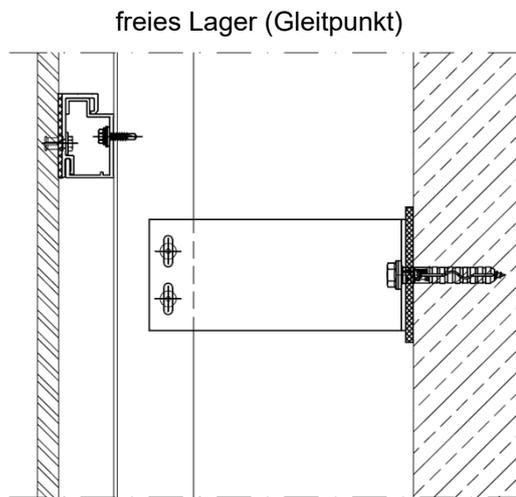
KEIL Hinterschnittanker KH für Feinsteinzeug - Fassadenplatten
