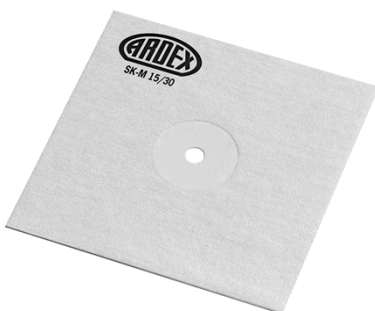
"ARDEX SK-M 15/30 TRICOM Dichtmanschette", 140 x 140 mm, für Rohrdurchdringungen Ø 15 – 30 mm
