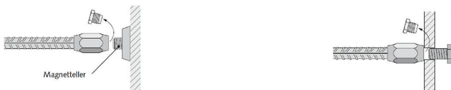
Bild B5: Befestigung mit Magnethalter bzw. Klebeteller (Befestigungszubehör)
