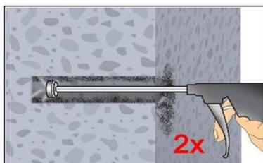
2d. Bohrloch mindestens 2x mit Druckluft (min. 6 bar, ölfrei) (Anhang B 6) über die gesamte Verankerungstiefe (ggf. Verlängerung verwenden) ausblasen, bis die ausströmende Luft staubfrei ist.
