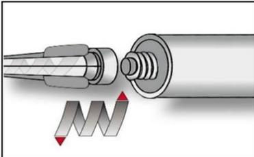
3. Statikmischer PM-19E aufschrauben und Kartusche in geeignetes Auspressgerät einlegen.
