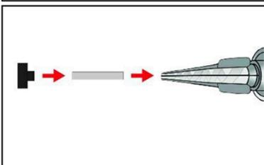
7. Verfüllstutzen MIT-VS und Mischerverlängerung MIT-VL sind gem. Tabelle B3 oder B4 zu verwenden.
