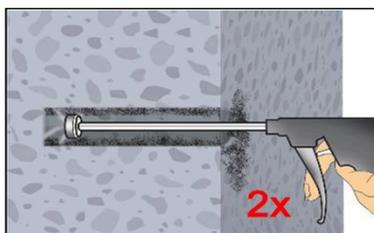
2d. Bohrloch mindestens 2x mit Druckluft (min. 6 bar, ölfrei) (Anhang B 4) über die gesamte Verankerungstiefe (ggf. Verlängerung verwenden) ausblasen, bis die ausströmende Luft staubfrei ist.
