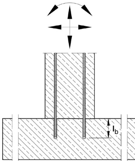
**Bild A2:** Platte / Balken an Wand oder Balken an Stütze
