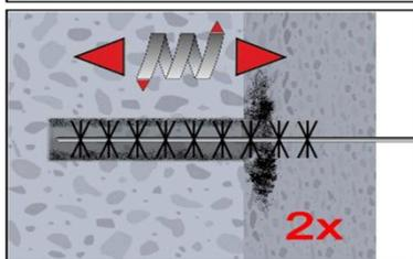
2e. Bohrloch mindestens 2x mit Bürste MIT-BS gemäß Tabelle B3 drehend über die gesamte Verankerungstiefe (ggf. Bürstenverlängerung MIT-BS verwenden) ausbürsten.
