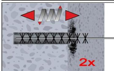
2b. Bohrloch mindestens 2x mit Bürste MIT-BS gemäß Tabelle B3 drehend über die gesamte Verankerungstiefe (ggf. Bürstenverlängerung MIT-BS verwenden) ausbürsten.
