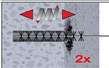
2b. Bohrloch mindestens 2x mit Bürste MIT-BS gemäß Tabelle B3 drehend über die gesamte Verankerungstiefe (ggf. MIT-BS verwenden) ausbürsten.
