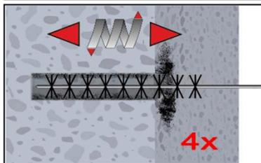
2b. Bohrloch mindestens 4x mit Bürste MIT-BS gemäß Tabelle B3 drehend über die gesamte Verankerungstiefe (ggf. Bürstenverlängerung MIT-BS verwenden) ausbürsten.
