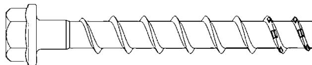
z.B. GETO PLUS TMK CE1 zinklamellenbeschichtet, Ausführung mit Sechskantkopf und Anbauteil
