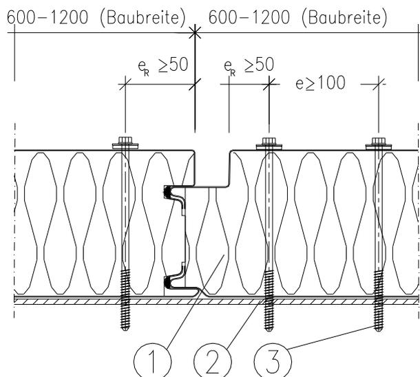
Direkte, sichtbare Befestigung des Sandwichelementes "Qbiss One S (Typ F-B)"
