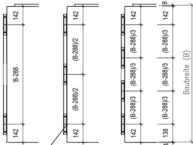
Lastverteiler werden werkseitig auf den Sandwichelementen befestigt
