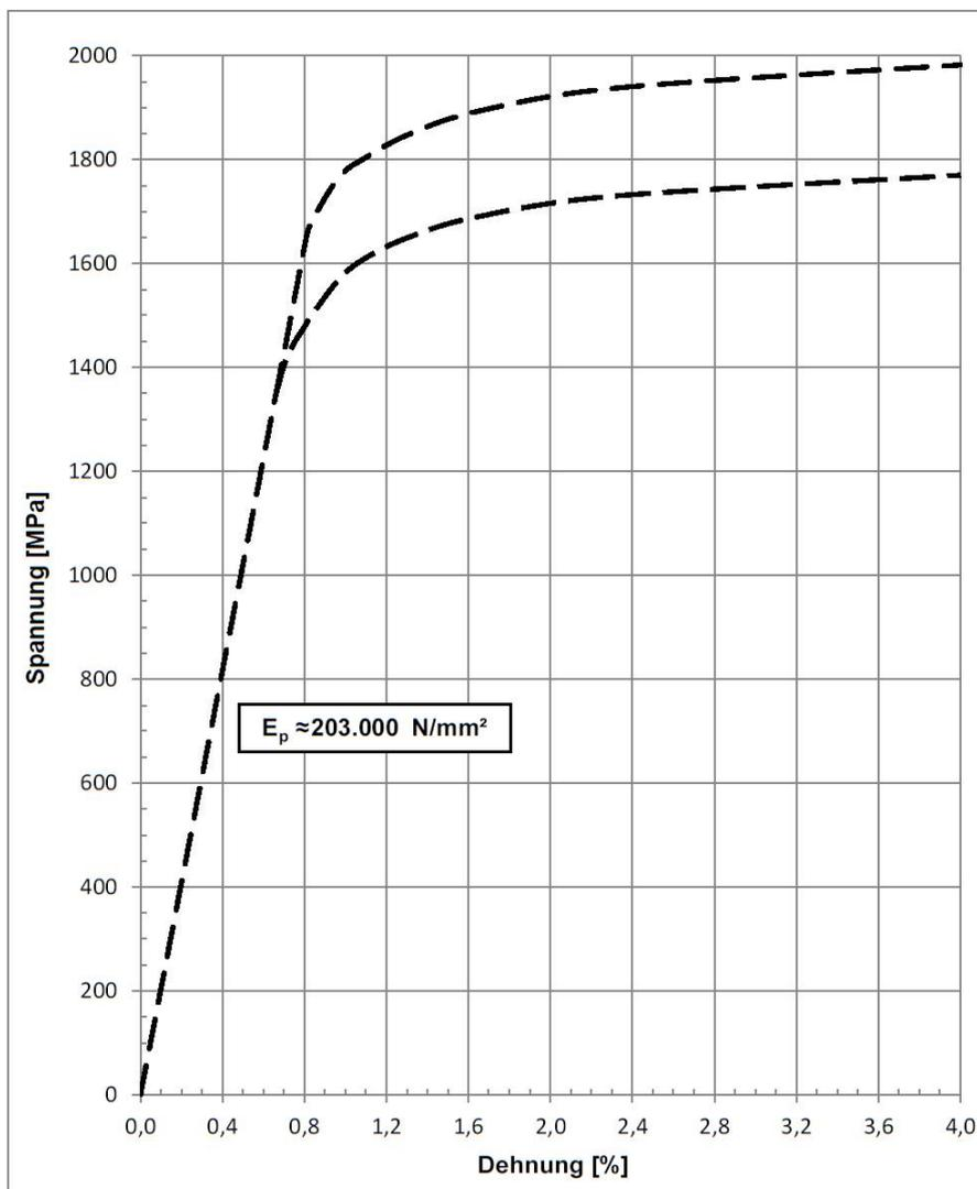
Die Linien geben eine Orientierung für den prinzipiellen Spannungs-Dehnungs-Verlauf bei Annahme des Rechenwerts des E-Moduls ( $E_p$ ) von 203.000 N/mm<sup>2</sup>
