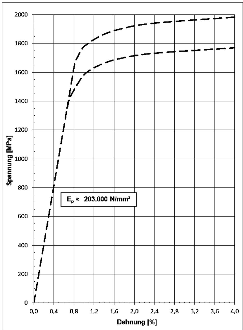
Die Linien geben eine Orientierung für den prinzipiellen Spannungs-Dehnungs-Verlauf bei Annahme des Rechenwerts des E-Moduls ( $E_p$ ) von 203.000 N/mm<sup>2</sup>.
