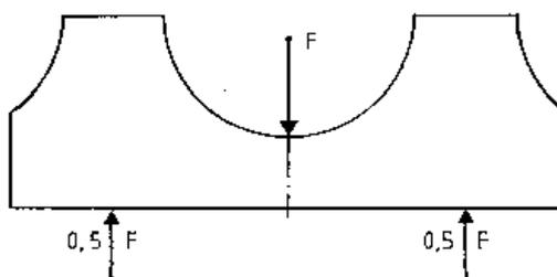
Bild 1: Belastungsanordnung Biegeversuch
