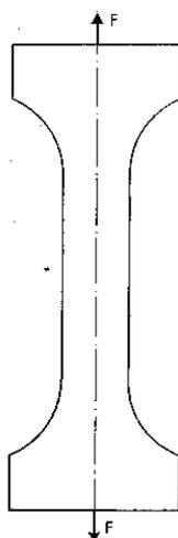
Bild 2: Belastungsanordnung Zugversuch
