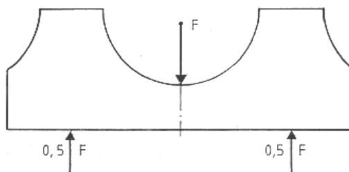
Bild 1: Belastungsanordnung Biegeversuch
