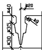
Decken und Dächer aus Spannbeton-Hohlplatten
