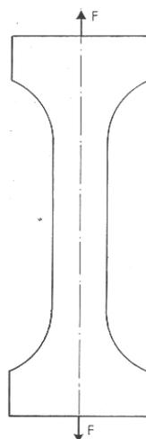
Bild 2: Belastungsanordnung Zugversuch
