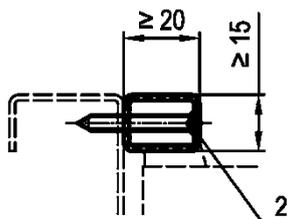
Rechteckrohrglasleiste ungefüllt und verschraubt
