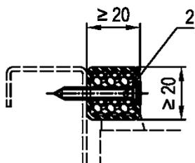
Rechteckrohrglasleiste werkseitig gefüllt und verschraubt
