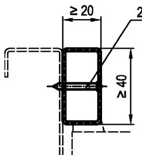
Rechteckrohrglasleiste ungefüllt und verschraubt
