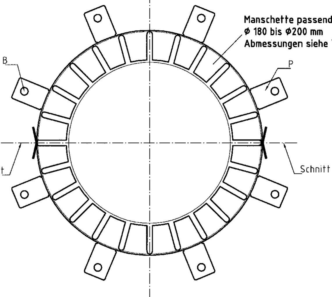
Manschette passend zum  $\varnothing$  180 bis  $\varnothing$  200 mm
