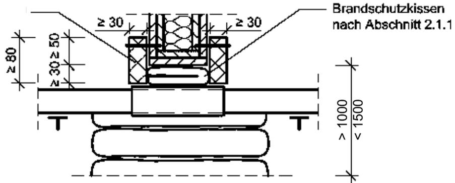
**Anschluss zu unteren Laibung bei Wanddicke < 160 mm**
