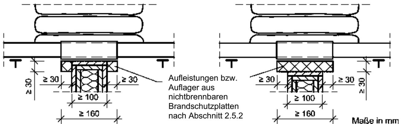
Aufleistungen bzw. Auflager aus nichtbrennbaren Brandschutzplatten nach Abschnitt 2.5.2
