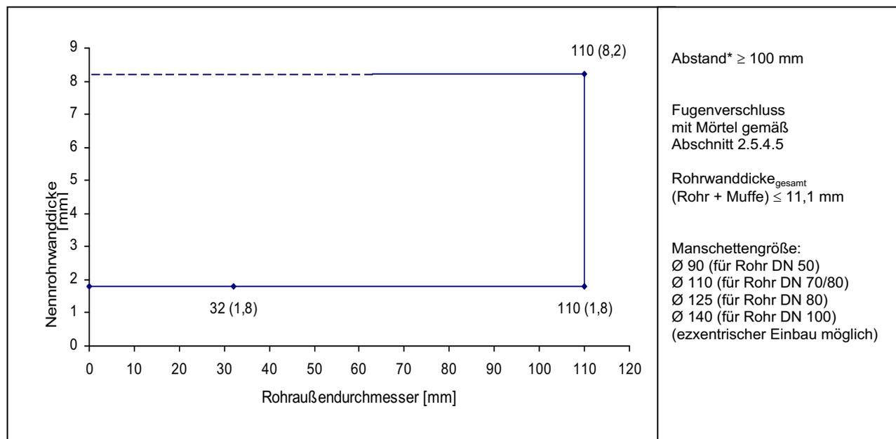
**Rohre aus weichmacherfreiem Polyvinylchlorid (PVC-U, PVC-HI), chloriertem Polyvinylchlorid (PVC-C) und Polypropylen (PP) gemäß den Ziffern 1 bis 7 der Anlage 32 bei Einbau in mindestens 200 mm dicke Decken**
