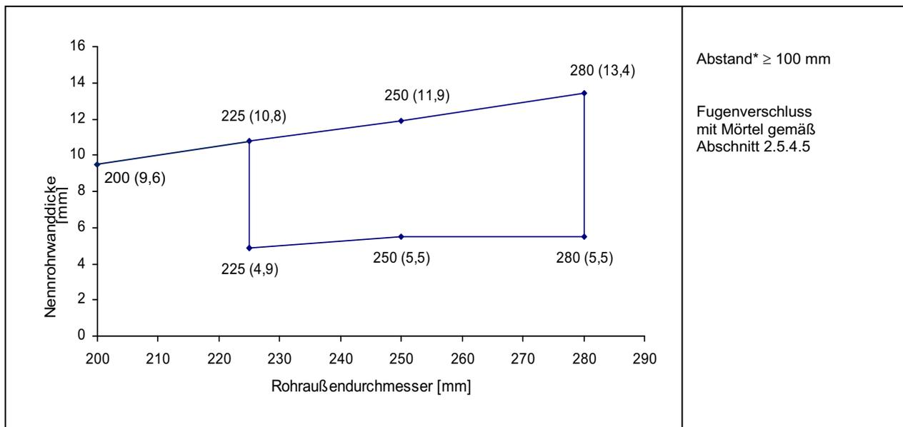
**A-5:** Rohre mit FEF-Isolierung, senkrecht zur Bauteiloberfläche durchgeführte Rohre, aufgesetzte Manschetten
