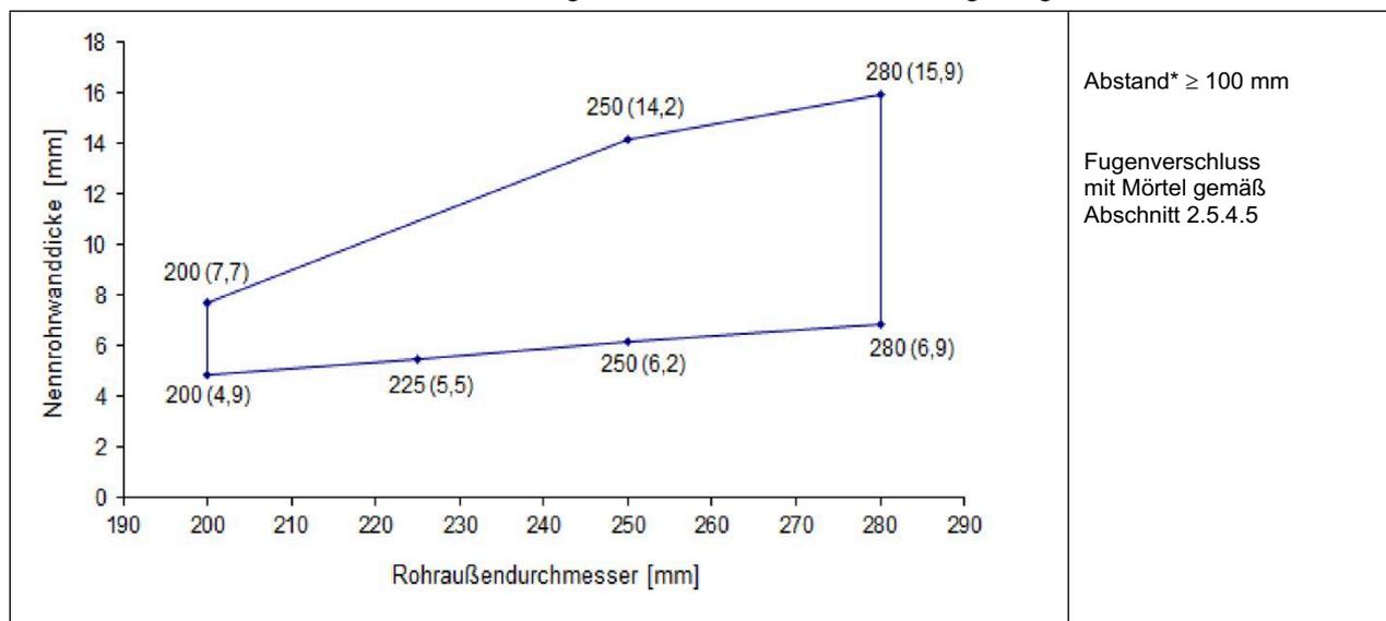
**B-5:** Rohre mit FEF-Isolierung, senkrecht zur Bauteiloberfläche durchgeführte Rohre, aufgesetzte Manschetten
