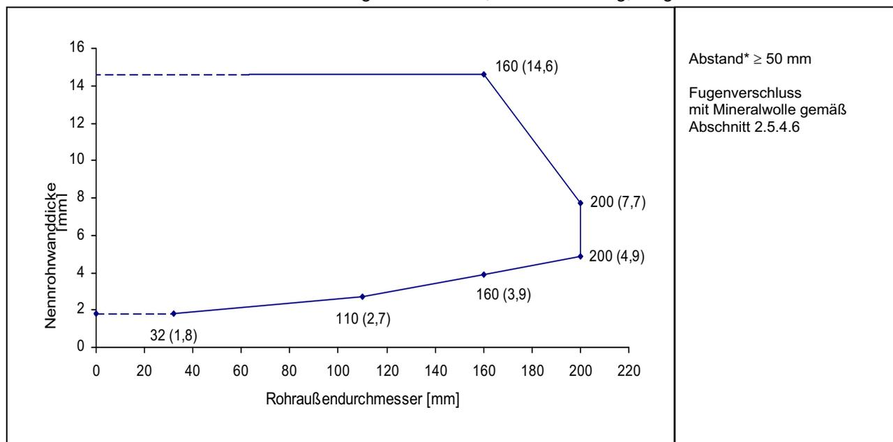
**B-3:** Rohre mit FEF-Isolierung, senkrecht zur Bauteiloberfläche durchgeführte Rohre, aufgesetzte Manschetten
