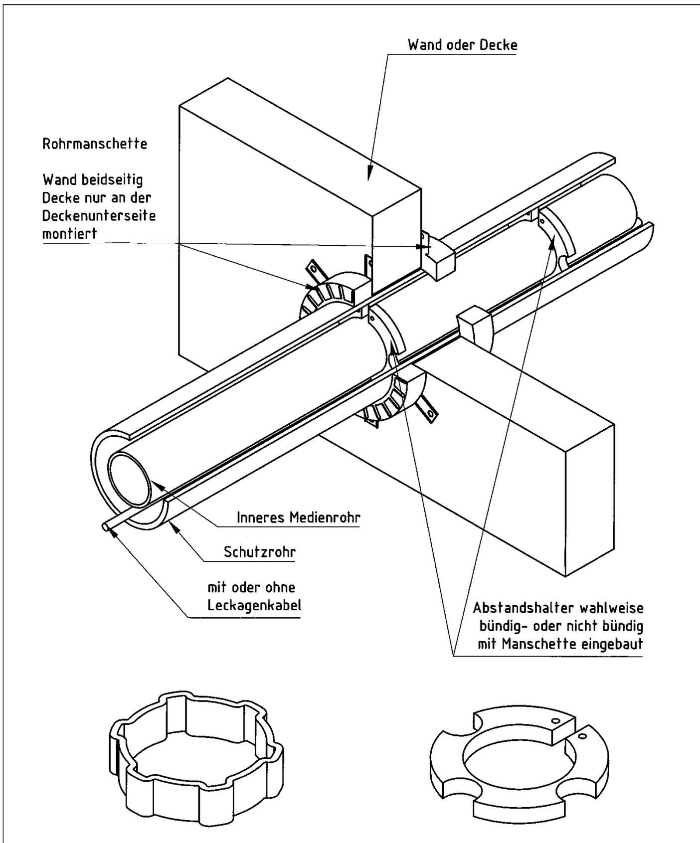
Feuerwiderstandsfähige Abschottung für Rohrleitungen aus Kunststoff "System Conlitt
