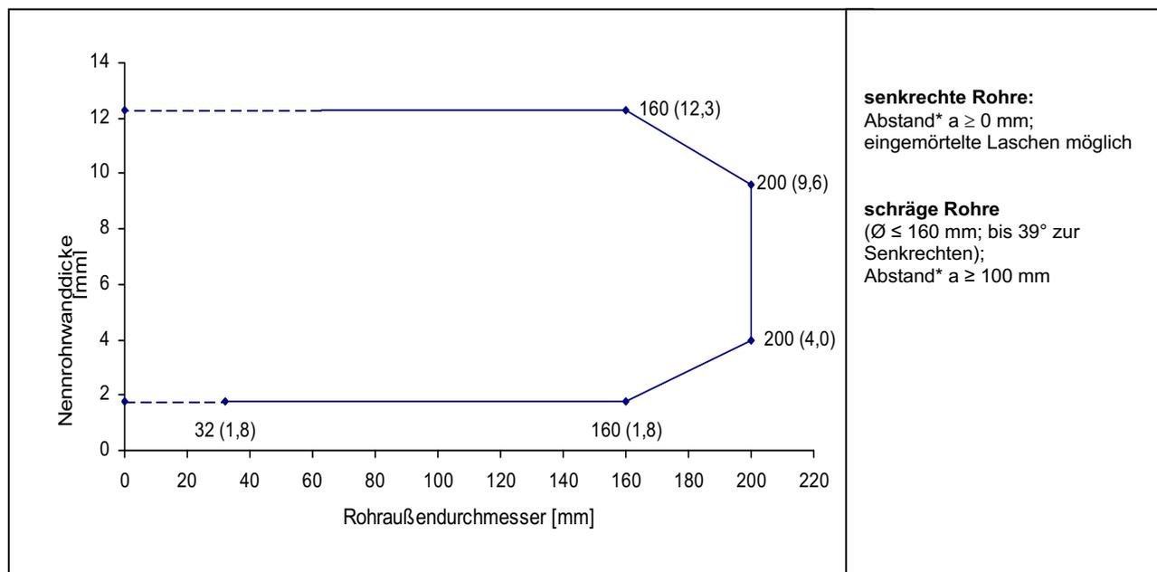
**A-2:** Rohrmanschette im Bereich von Muffen, senkrecht zur Bauteiloberfläche durchgeführte Rohre, keine Isolierung, aufgesetzte Manschetten
