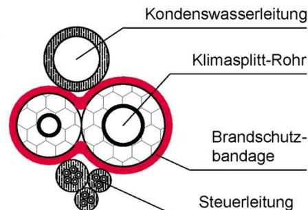
Feuerwiderstandsfähige Abschottung für elektrische Leitungen und/oder Rohrleitungen aus Kunststoff oder Metall "ZZ M20-S90"
