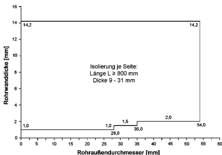
\*) Die Isolierung/ Streckenisolierung darf wahlweise durch die Abschottung geführt werden oder beidseitig an der Schottoberfläche angrenzen (Fall LS/ CS).
