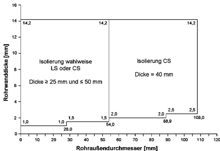
\*) FOAMGLAS der Deutsche FOAMGLAS GmbH; Verklebung der Rohrschalen mit Kleber PC 18 und Sicherung durch zwei Spannbänder je Seite in 10 cm bzw. 40 cm Abstand zur Schottoberfläche
