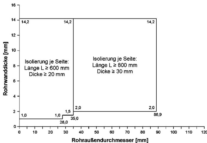
\*) Bei Einbau in nichttragende, raumabschließende Wandkonstruktionen gem. Abschnitt 2.2.1, Tab. 3, sind nur Rohre mit  $\varnothing \leq 35$  mm zulässig (s. Anlage 2).
