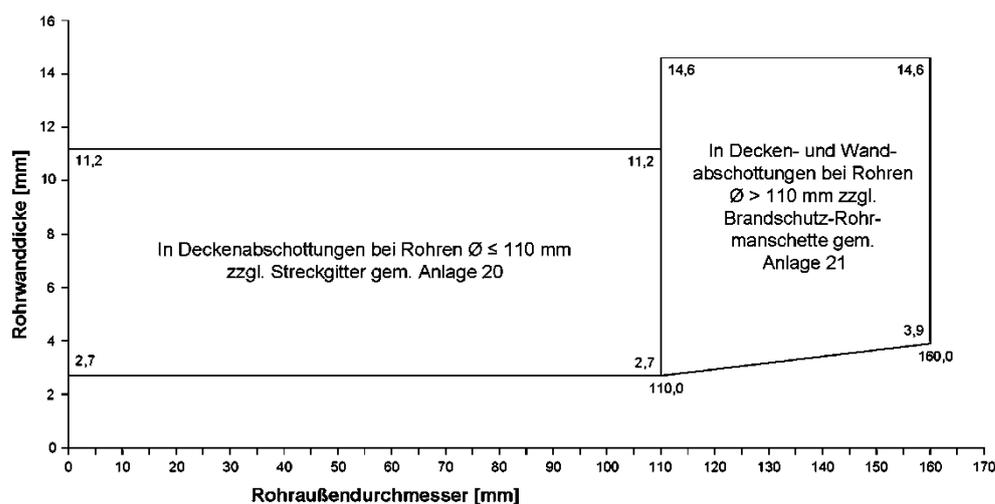
Feuerwiderstandsfähige Abschottung für elektrische Leitungen und/oder Rohrleitungen aus Kunststoff oder Metall "ZZ M20-S90"
