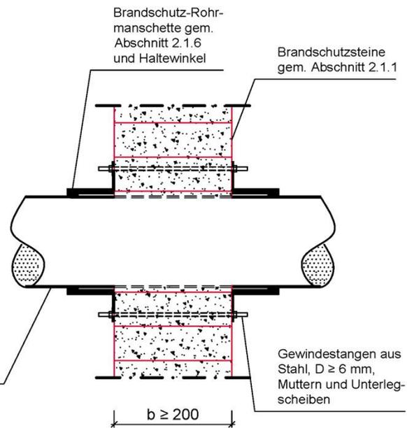
Feuerwiderstandsfähige Abschottung für elektrische Leitungen und/oder Rohrleitungen aus Kunststoff oder Metall "ZZ M20-S90"
