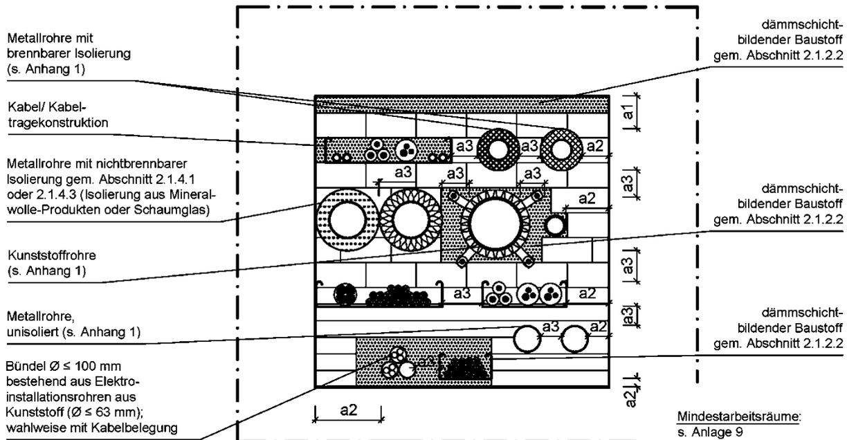
Teilbereiche zwischen Installationen sowie zwischen Installationen und den Öffnungslaibungen können bis zu einer Größe von maximal 450 mm x 500 mm (Breite x Höhe) oder 0,225 m<sup>2</sup> mit dem dämmschichtbildenden Baustoff gem. Abschnitt 2.1.2.2 ausgefüllt werden. Spalte zwischen Brandschutzsteinen gem. Abschnitt 2.1.1 und Öffnungslaibung können bis zu einer Breite von 60 mm verschlossen werden.
