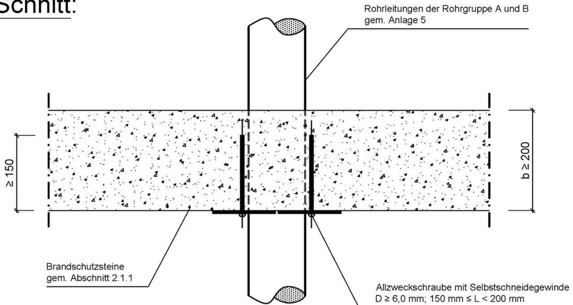
Feuerwiderstandsfähige Abschottung für elektrische Leitungen und/oder Rohrleitungen aus Kunststoff oder Metall "ZZ M20-S90"
