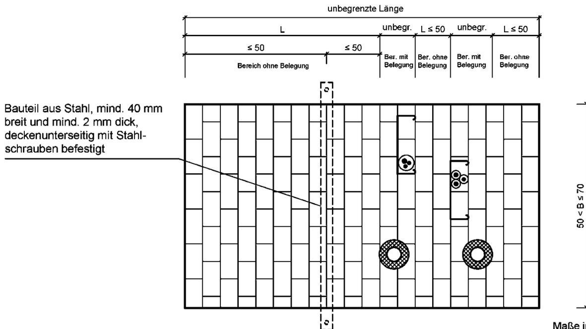
Bei Einbau in Öffnungen in massiven Decken (s. Anlagen 14 - 16) mit einer Breite  $50 \text{ cm} < B \leq 70 \text{ cm}$ , muss in Abschottungen ohne Belegung bzw. in Bereichen ohne Belegung mit einer Länge  $L > 50 \text{ cm}$  eine der folgenden Maßnahmen erfolgen (vgl. Abschnitt 2.5.3.6):
