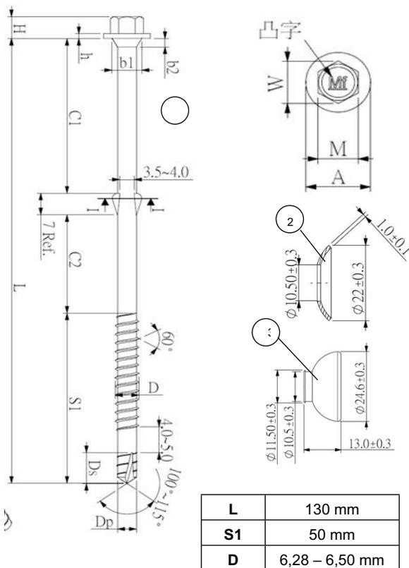
**Bild 10: Shen Fung Spezialbohrschraube 6,5 x 130 mm**
