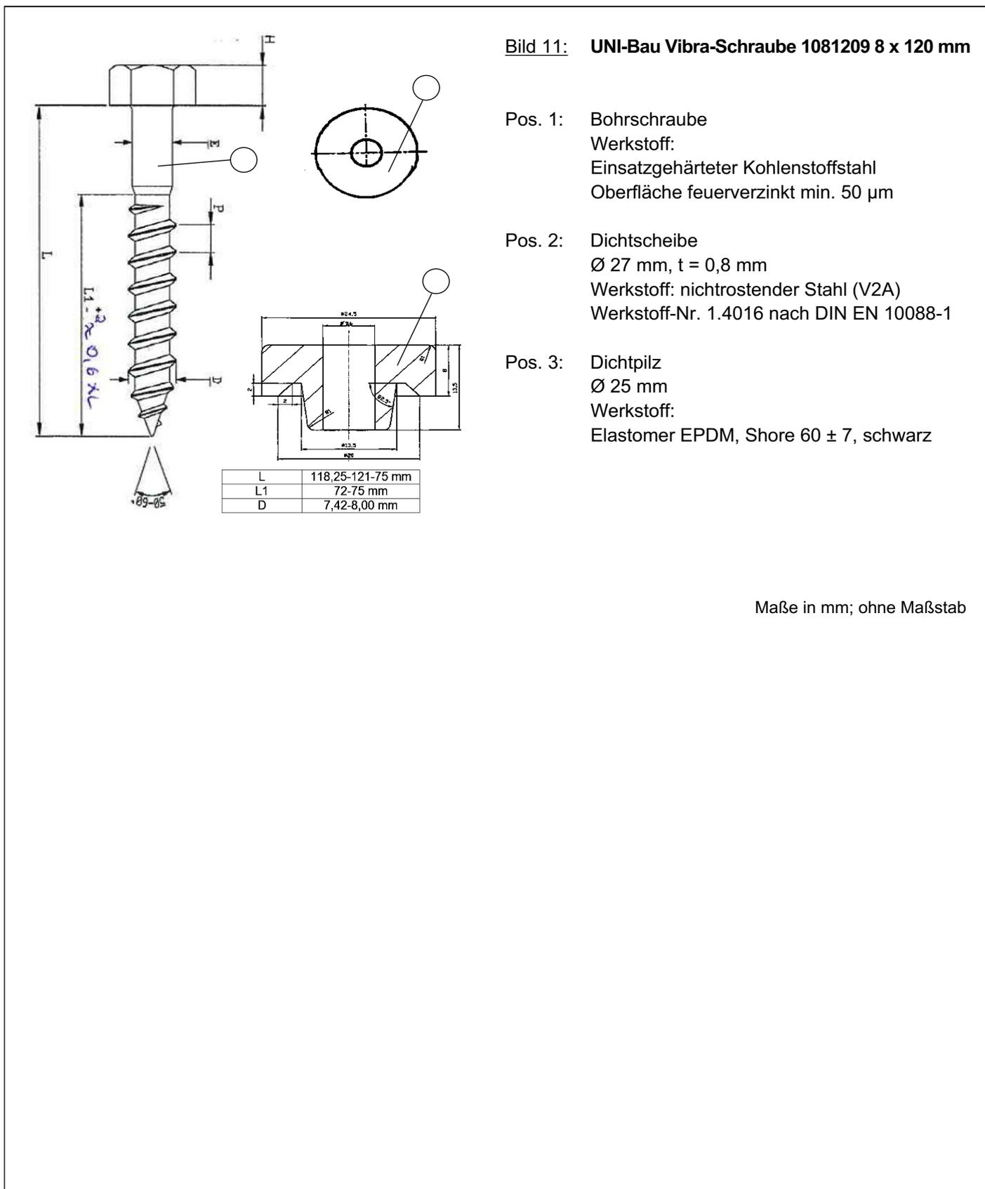
**Bild 11: UNI-Bau Vibra-Schraube 1081209 8 x 120 mm**
