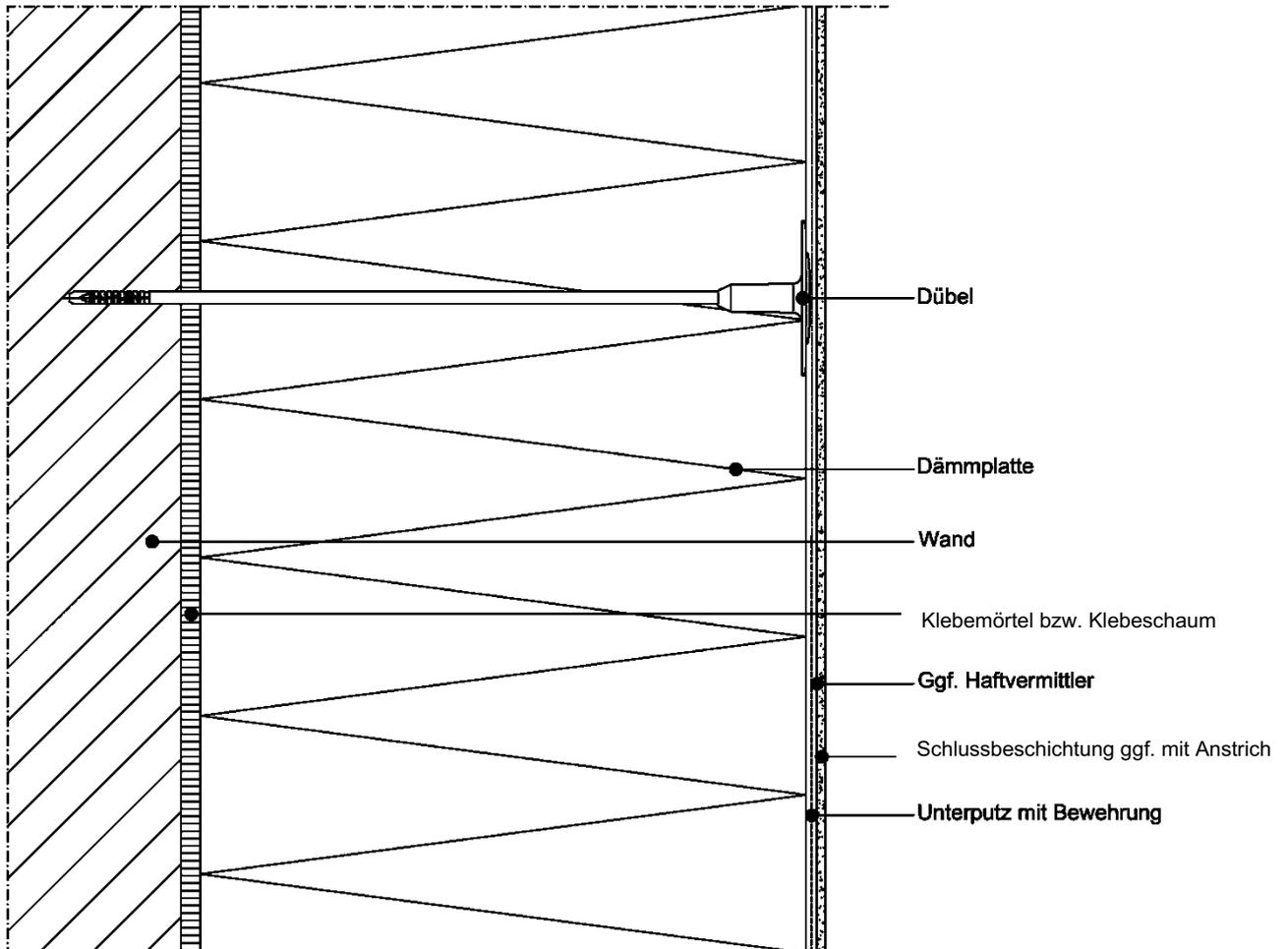
Verdübelung bei zweilagiger Verlegung der EPS-Platten Anlage 1.2
