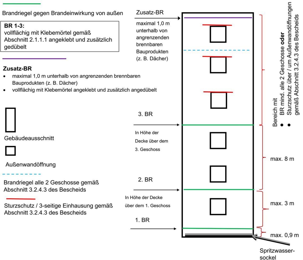
**Erklärung für die Bauart "WDVS an Außenwänden"**
