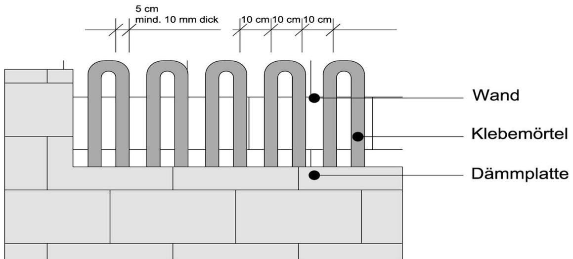
**Aufbau des WDVS mit EPS-Platten
