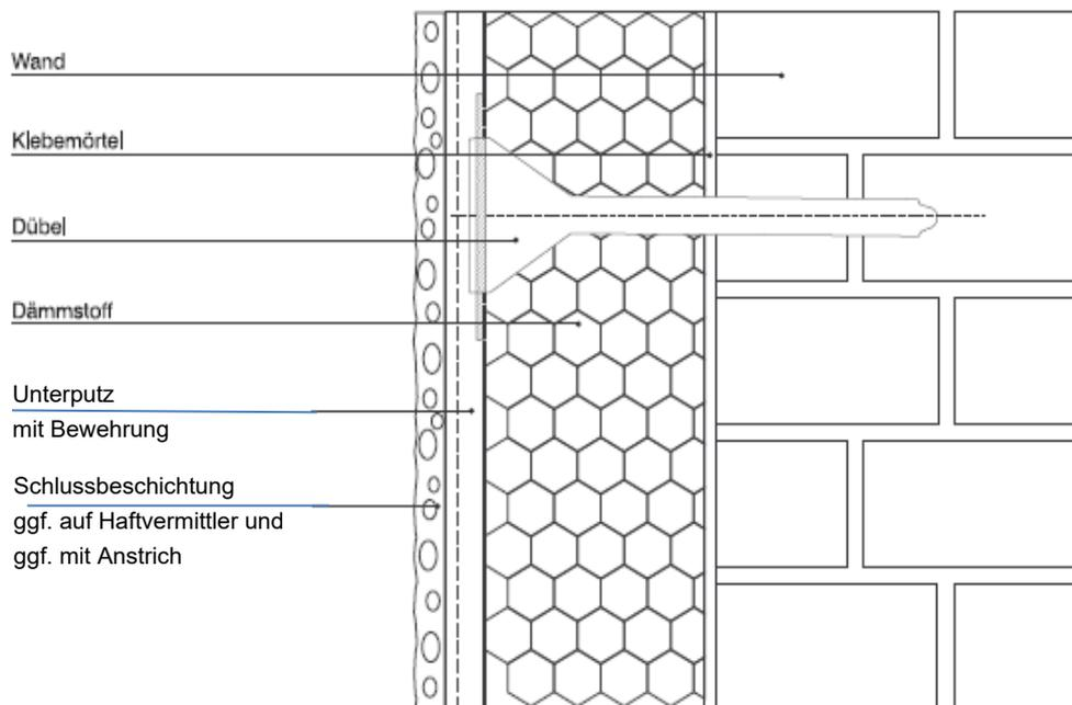
Teilflächige Verklebung der Dämmplatten auf dem Untergrund
