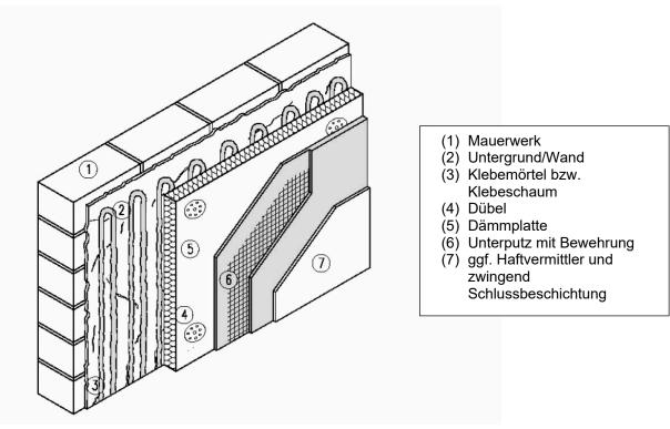
Teilflächige Verklebung der Dämmplatten auf den Untergrund
