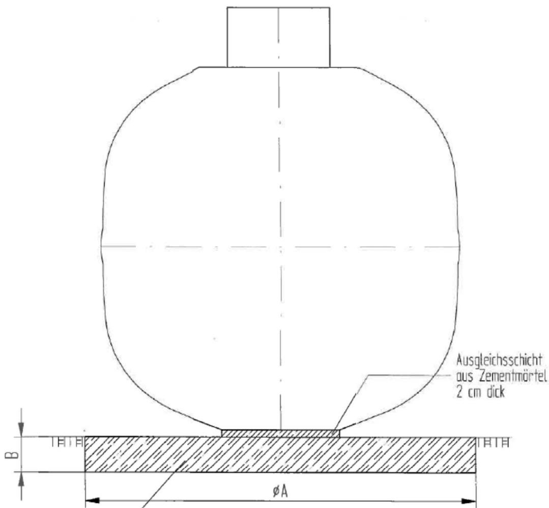
Stahlbetonplatte B25 mit konstruktiver Bewehrung oben und unten BST Q131. Oberfläche plan- u. waagrecht
