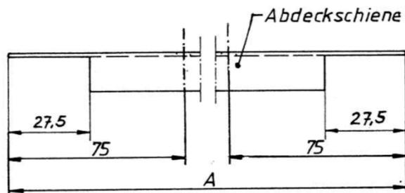
Maß A ist so zu wählen, daß die Verbindung vollständig abgedeckt ist.
