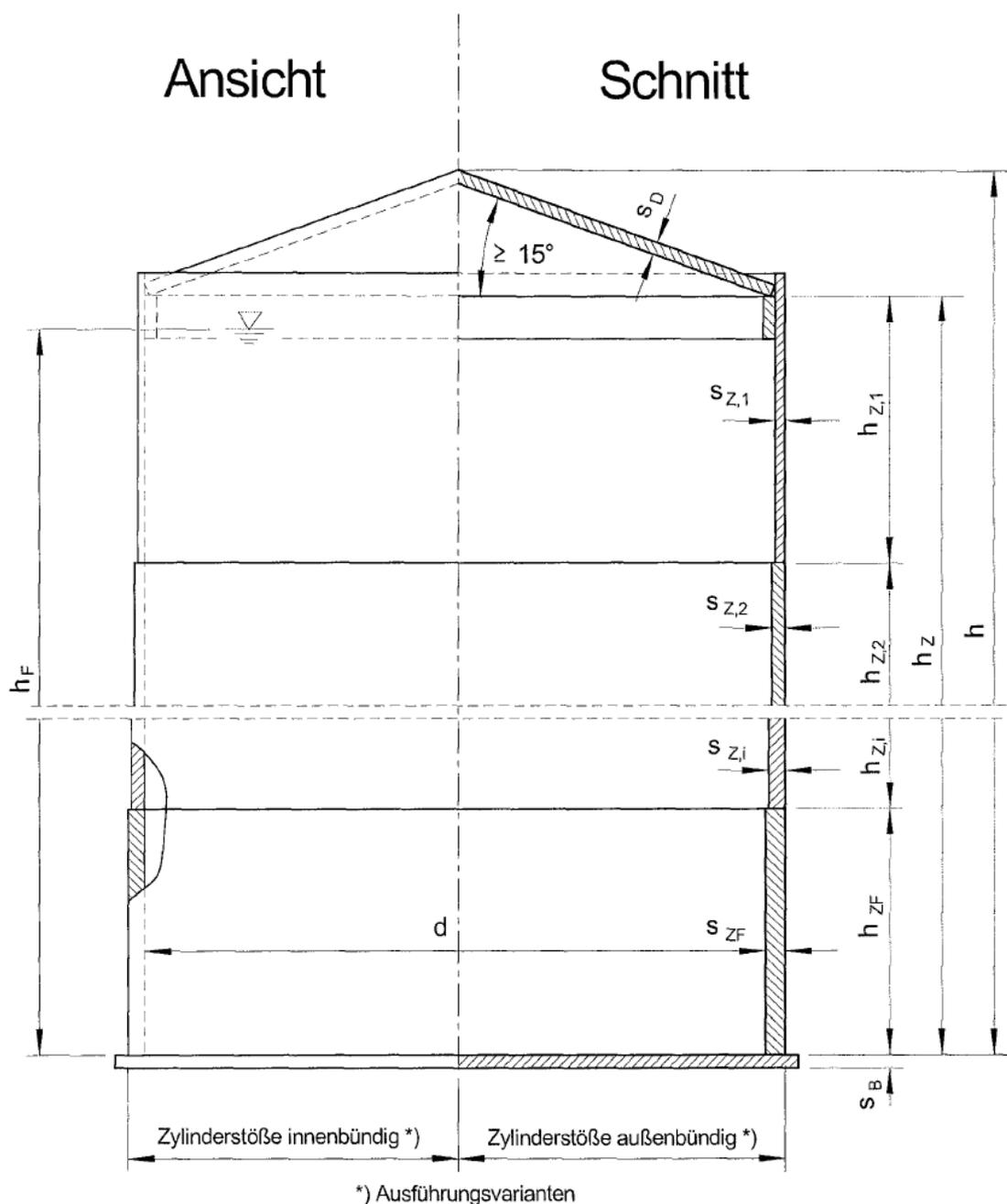
Zylindrische Flachbodenbehälter und Auffangvorrichtungen aus Polyethylen PE-HD aus verschweißten Tafeln (Tafelbehälter)
