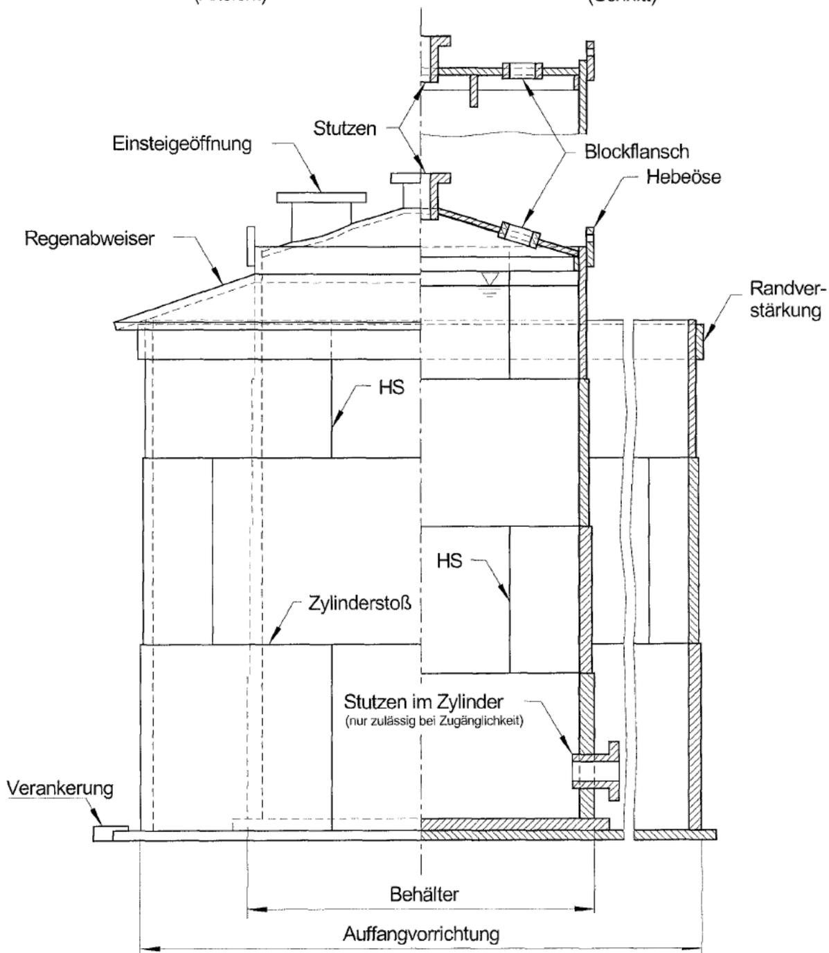
Zylindrische Flachbodenbehälter und Auffangvorrichtungen aus Polyethylen PE-HD aus verschweißten Tafeln (Tafelbehälter)
