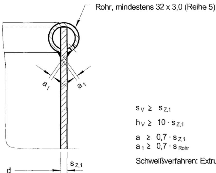
Zylindrische Flachbodenbehälter und Auffangvorrichtungen aus Polyethylen PE-HD aus verschweißten Tafeln (Tafelbehälter)
