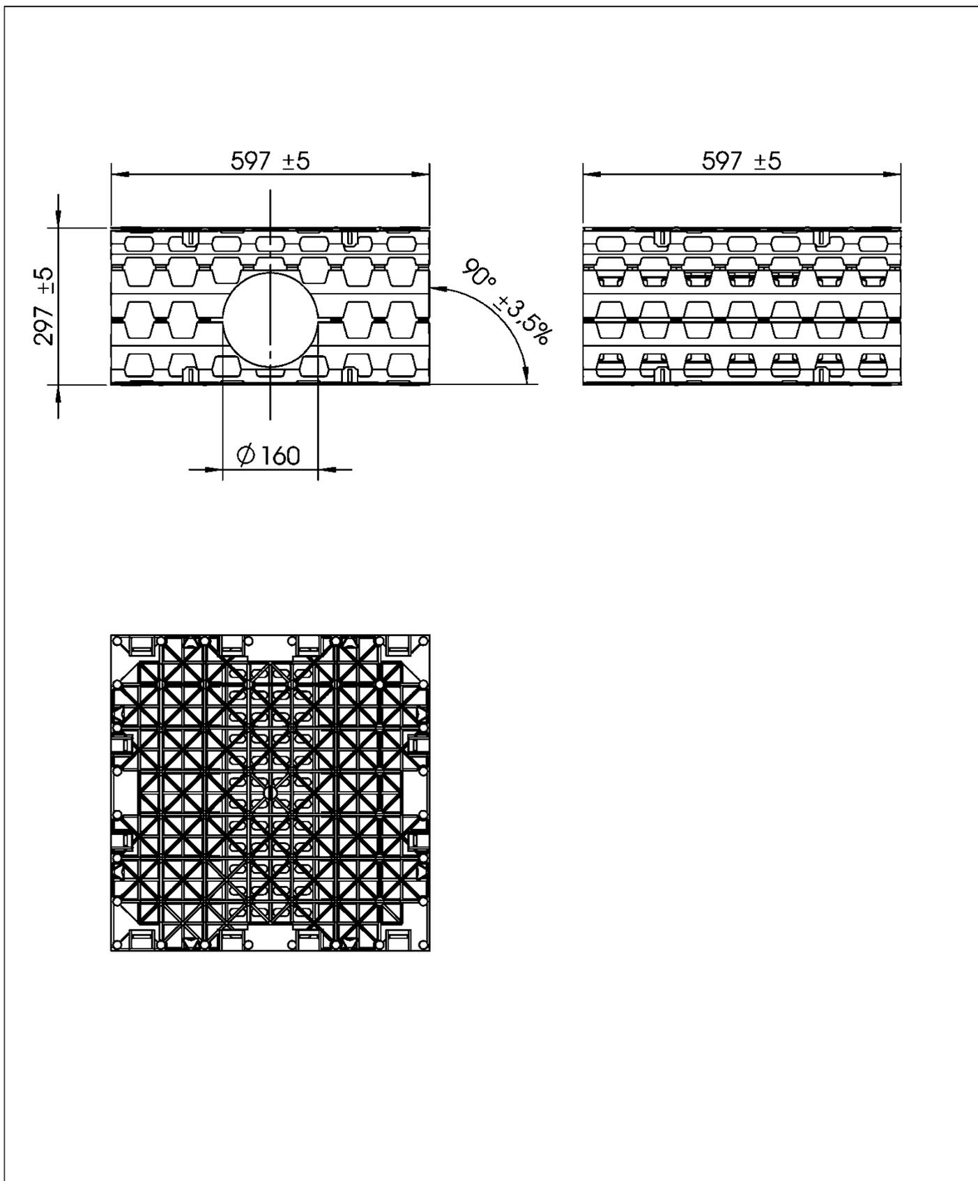
Versickerungsblöcke für die Versickerung von Niederschlagswasser mit der Bezeichnung "Variobox"
