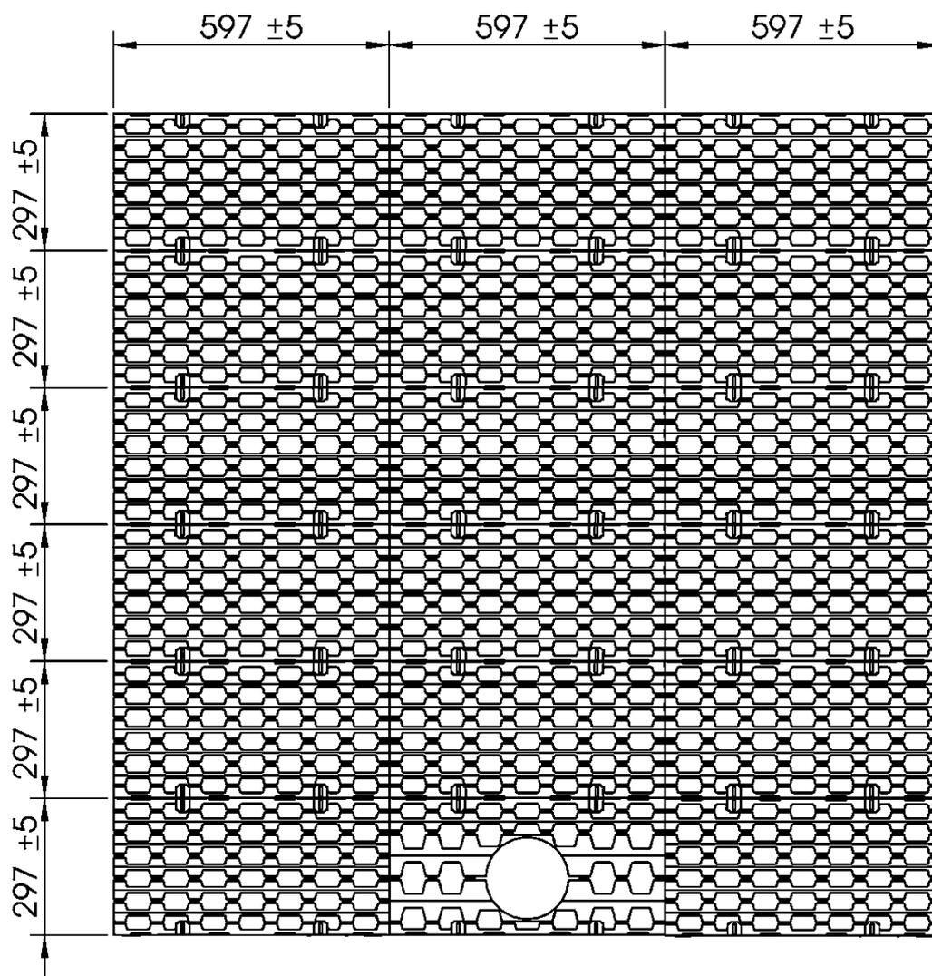
Versickerungsblöcke für die Versickerung von Niederschlagswasser mit der Bezeichnung "Variobox"
