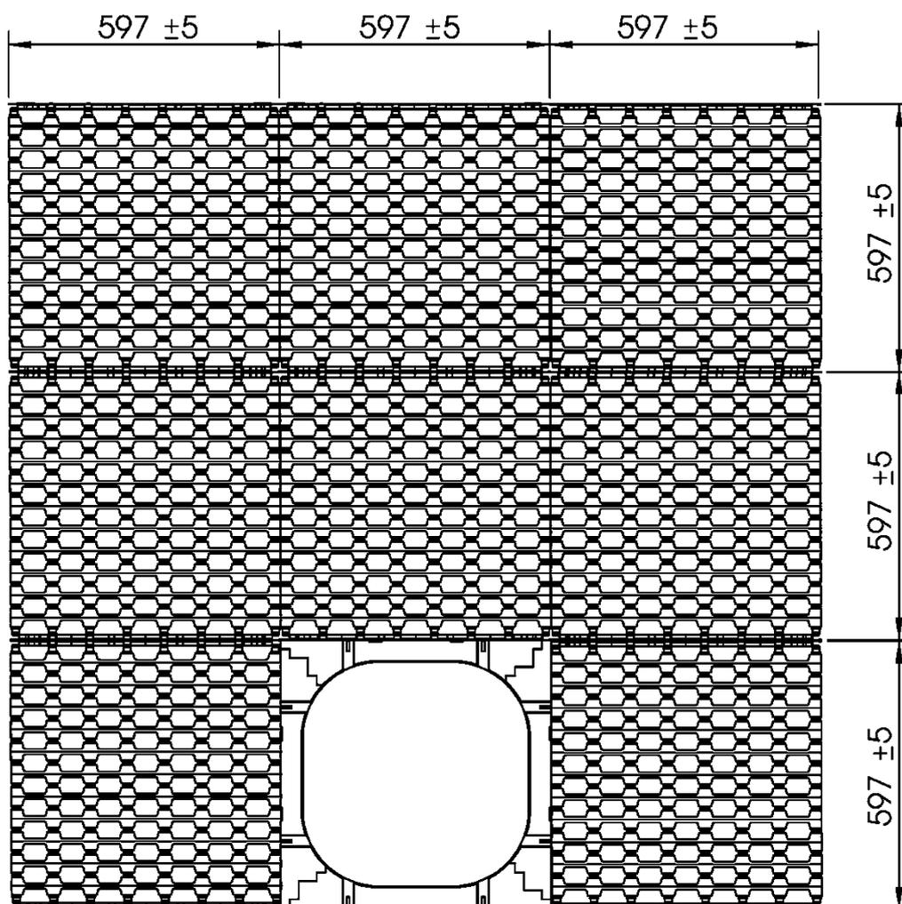
Versickerungsblöcke für die Versickerung von Niederschlagswasser mit der Bezeichnung "Variobox"
