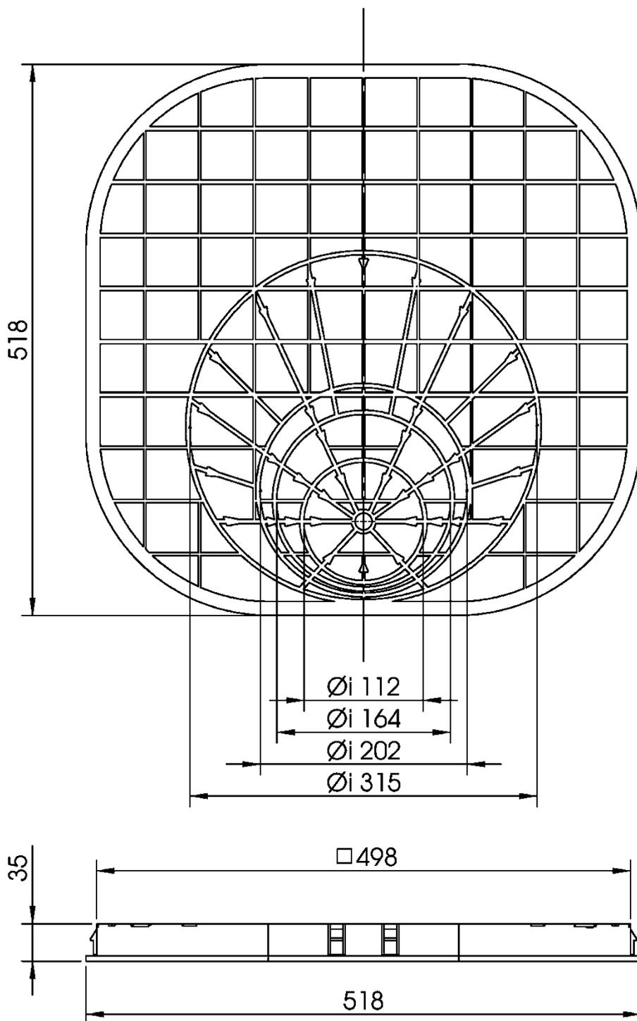
Versickerungsblöcke für die Versickerung von Niederschlagswasser mit der Bezeichnung "Variobox"
