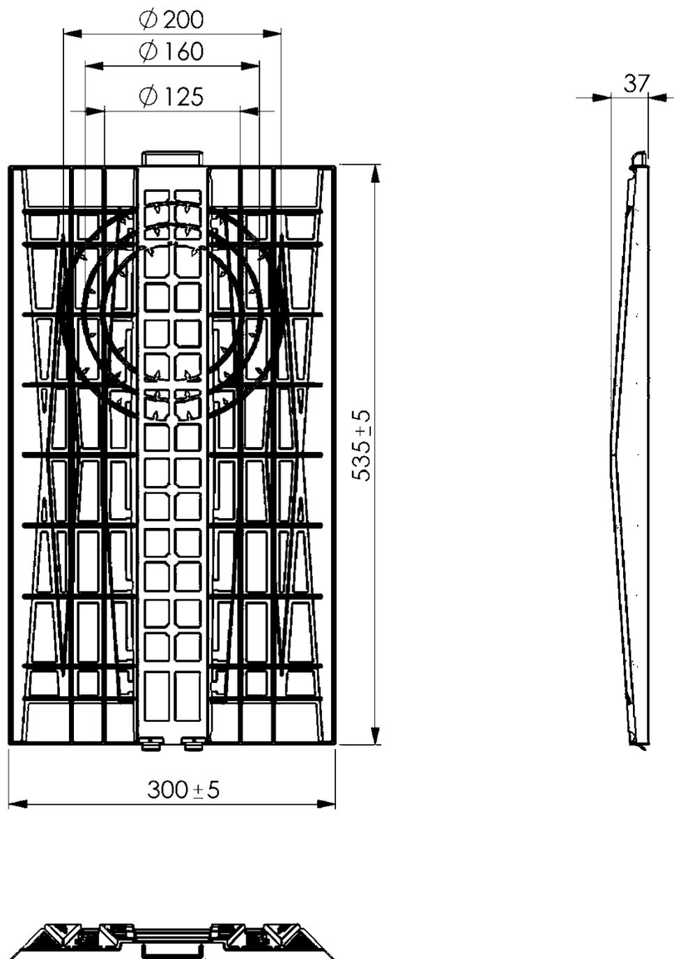
Versickerungsblöcke für die Versickerung von Niederschlagswasser mit der Bezeichnung "Variobox"
