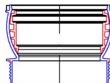
Anschlussoberteil DN/OD 160/200 mit integriertem Kugelgelenk
