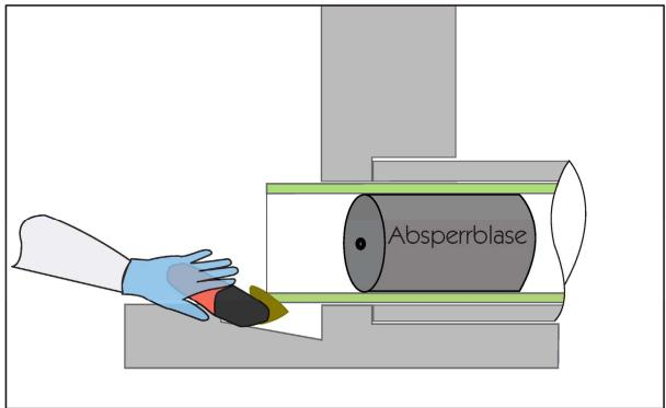
Bauprodukte und deren Verwendung zur Ausführung von Schlauch- und PE-Lineranbindungen an Schachtbauwerke mit dem Epoxidharzsystem mit der Bezeichnung "Harz8 RP20"
