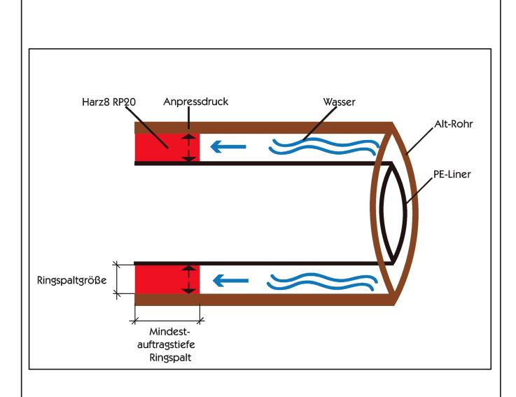
Bauprodukte und deren Verwendung zur Ausführung von Schlauch- und PE-Lineranbindungen an Schachtbauwerke mit dem Epoxidharzsystem mit der Bezeichnung "Harz8 RP20"
