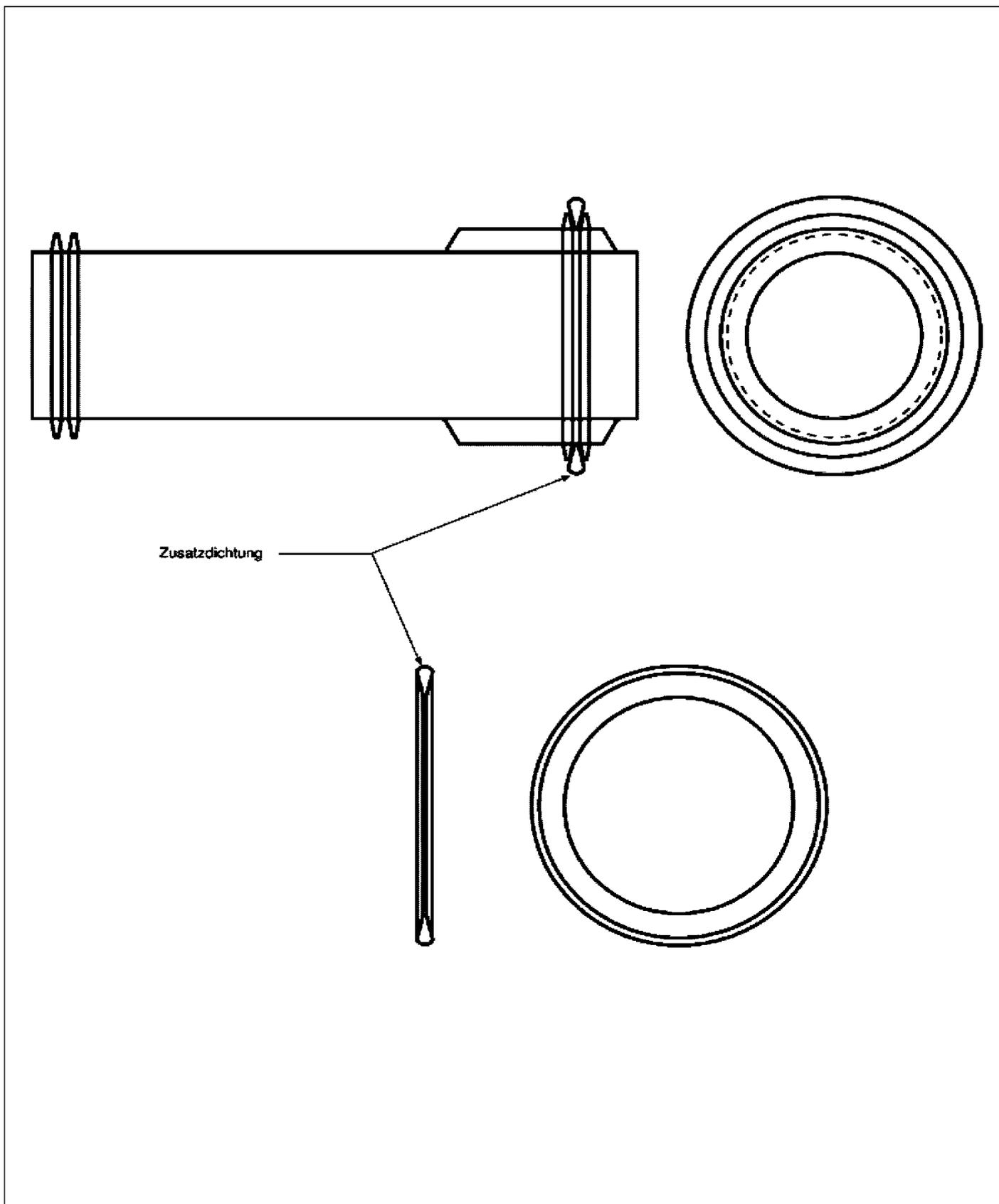
Rohrinnendichtungen mit der Bezeichnung "Pipe-Seal" für erdverlegte Abwasserrohre der Nennweite DN 150 bis DN 800
