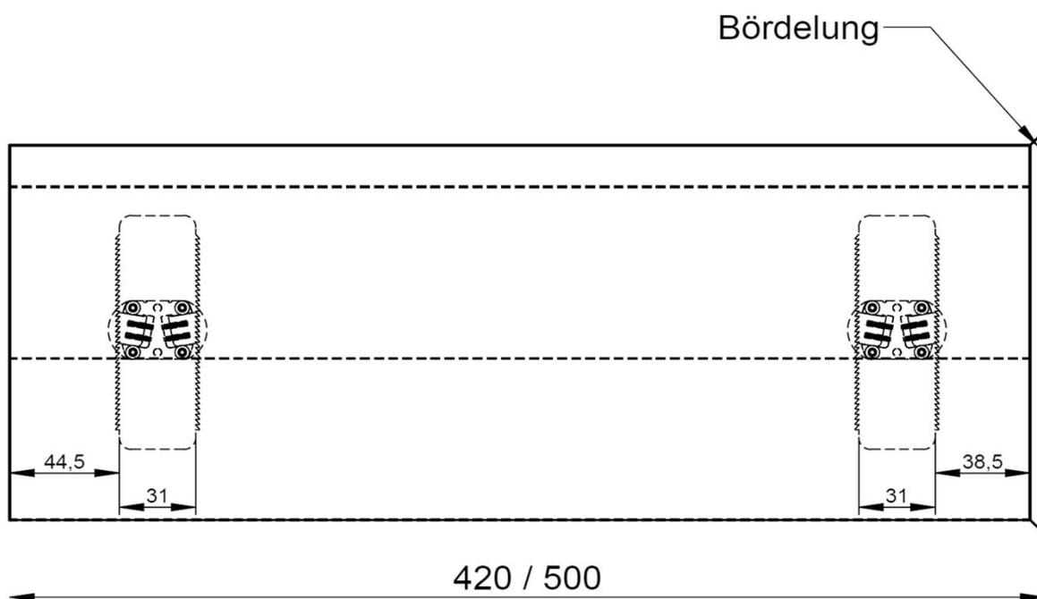
Rohrinnendichtungen mit der Bezeichnung "Pipe-Seal" für erdverlegte Abwasserrohre der Nennweite DN 150 bis DN 800
