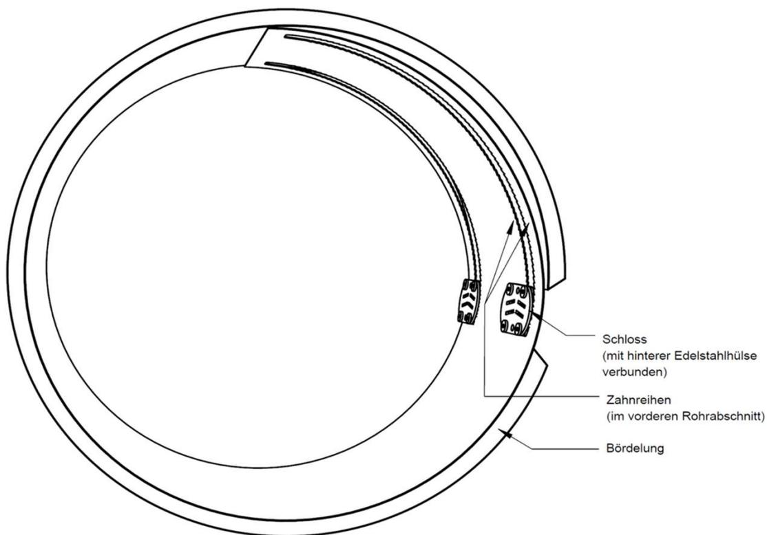
Rohrinnendichtungen mit der Bezeichnung "Pipe-Seal" für erdverlegte Abwasserrohre der Nennweite DN 150 bis DN 800
