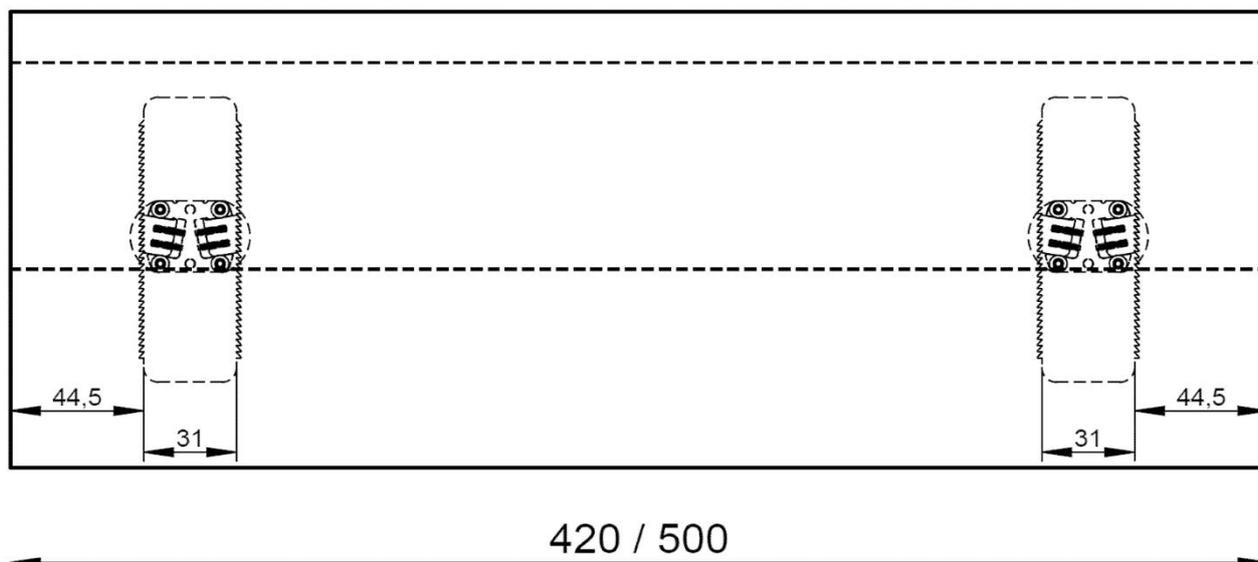
Rohrinnendichtungen mit der Bezeichnung "Pipe-Seal" für erdverlegte Abwasserrohre der Nennweite DN 150 bis DN 800
