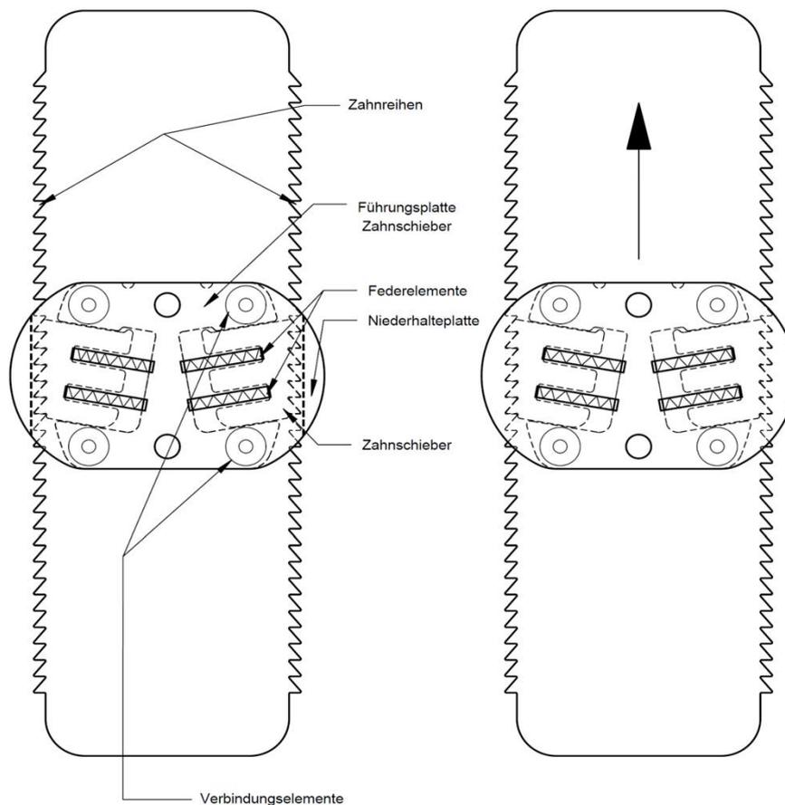
Rohrinnendichtungen mit der Bezeichnung "Pipe-Seal" für erdverlegte Abwasserrohre der Nennweite DN 150 bis DN 800
