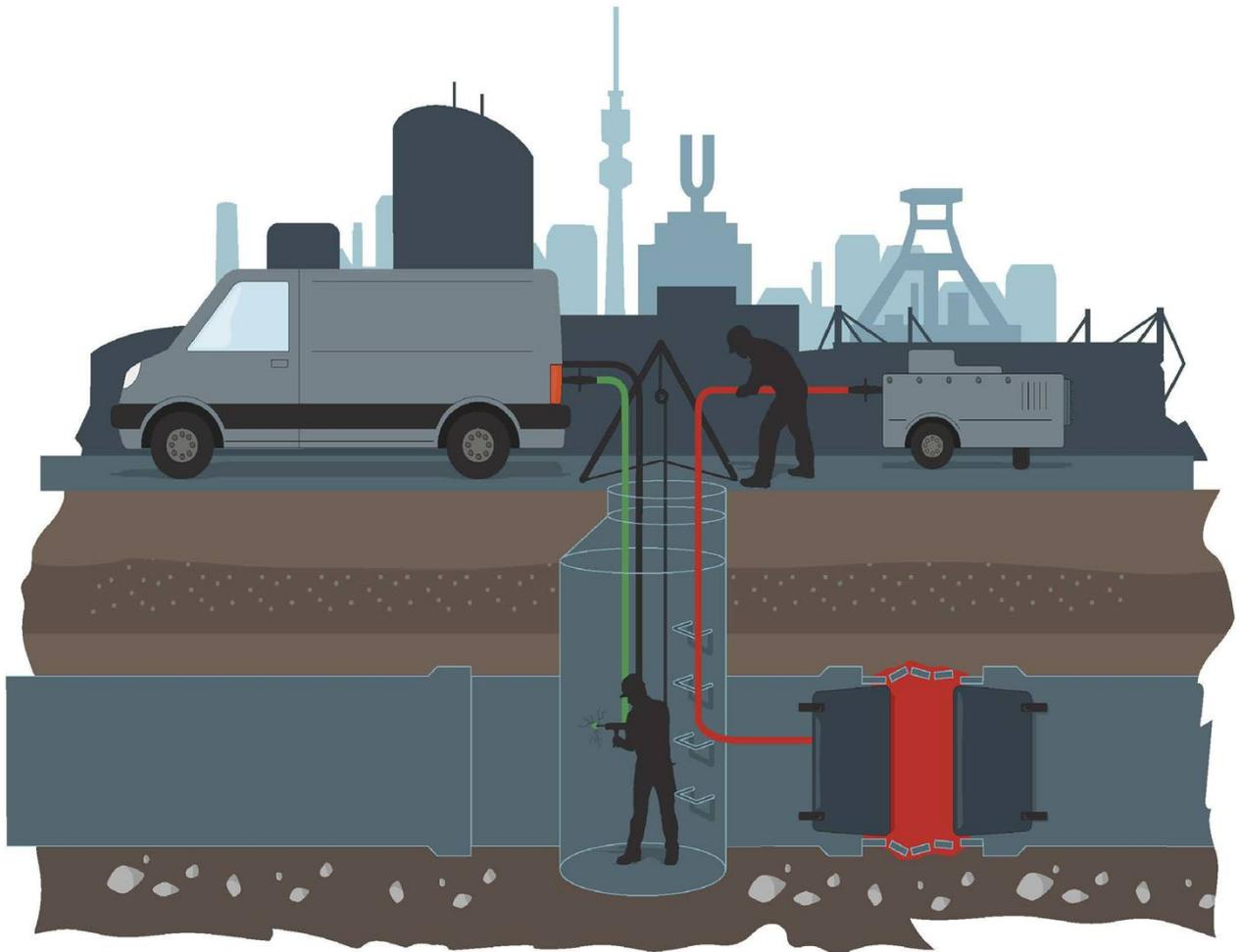
Bauprodukte und deren Verwendung zur Ausführung von Kurzlinern mit der Bezeichnung "WILLKAT PL/SL Short Liner System" zur Sanierung erdverlegter schadhafter Abwasserleitungen im Nennweitenbereich DN 100 bis DN 500
