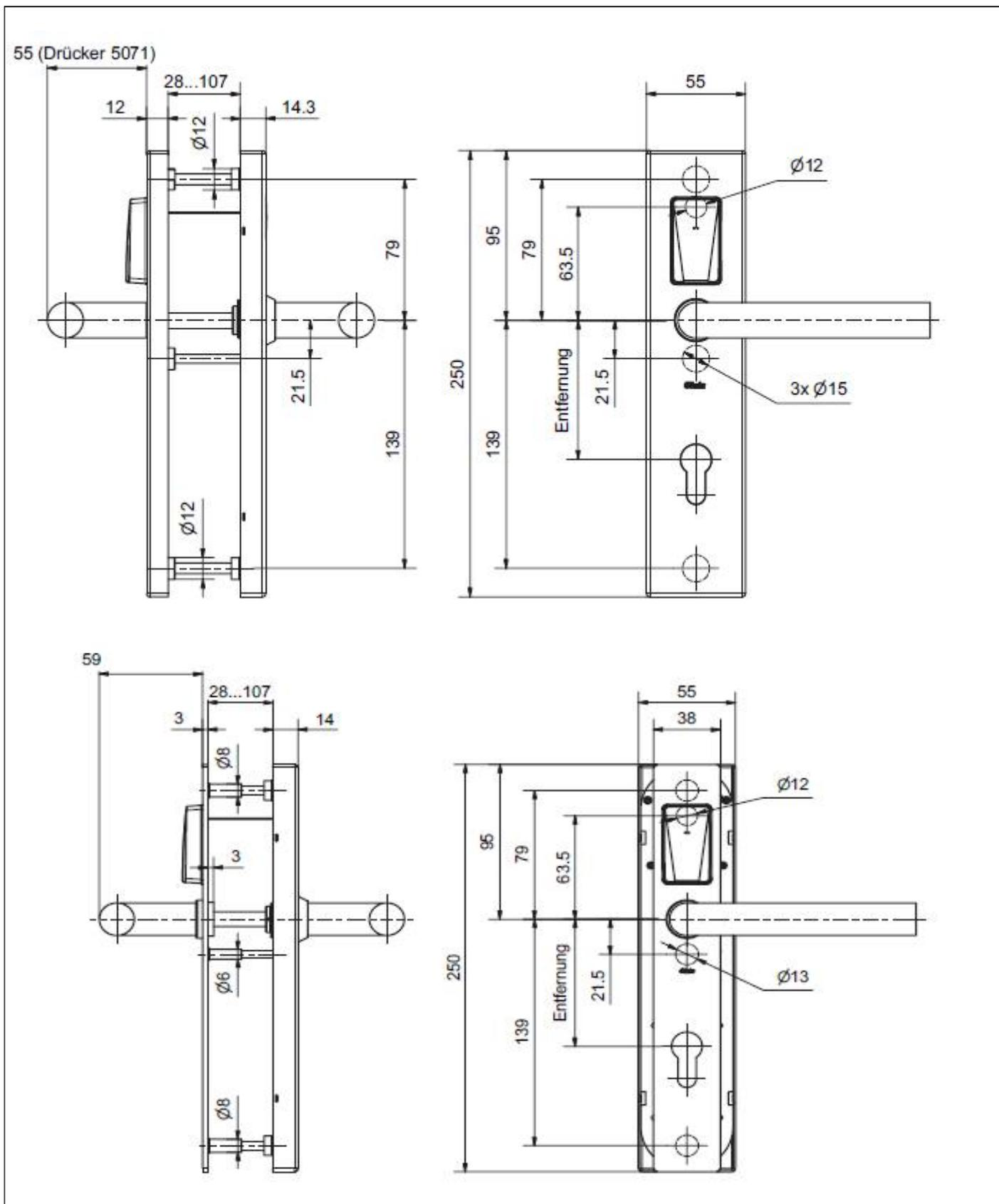
Konstruktion exemplarisch für E- Schutzbeschlag ES-1 mit Innentaster in breit und E-Schutzbeschlag Stahl schmal
