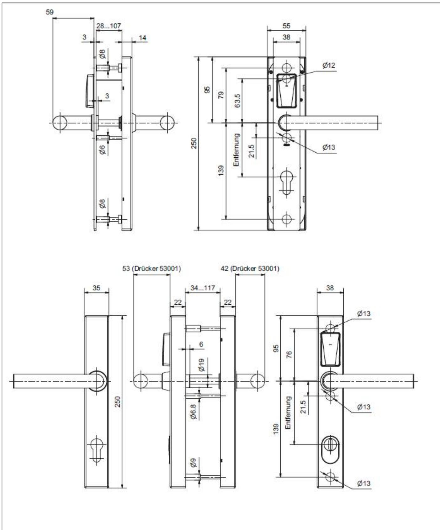
Konstruktion exemplarisch für E- Schutzbeschlag schmal bzw. E-Organisationsbeschlag ES-1 schmal
