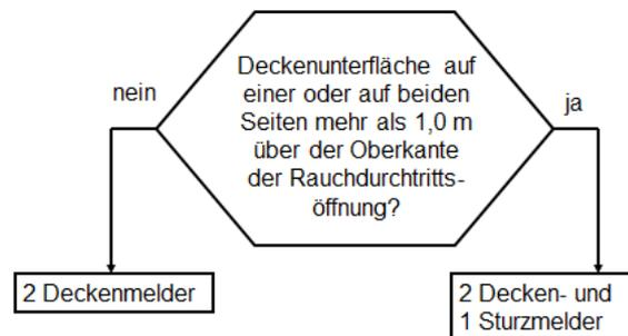
Bild 3: Entscheidungsdiagramm
