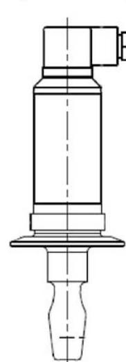
Überfüllsicherung mit standgrenzschalter
