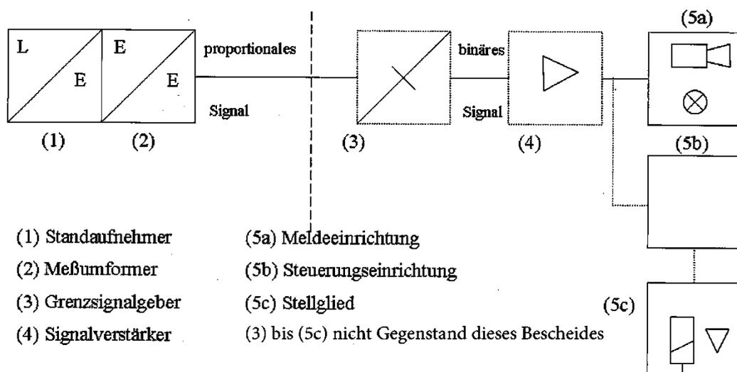
Standaufnehmer (Radar-Antennen) "Rosemount 5300" mit angebautem Messumformer als Bauteil von Überfüllsicherungen
