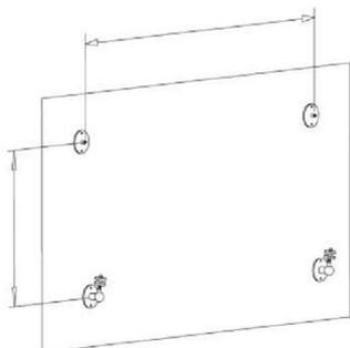
Die Ankerpunkte für die Wandhalter sind genau auszumessen und zu bohren. Dazu ist für die Einbausituation geeignetes Werkzeug zu verwenden. Die exakte Einbauposition ist in Konformität mit den Richtlinien der AbZ und des Herstellers zu ermitteln. Die Wandhalter werden danach mit einem für das Mauerwerk passendem Befestigungssystem montiert.
