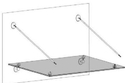
Die so vormontierte Glasscheibe wird in die unteren Wandhalter eingehängt, und mit Bolzen fixiert. Die Bolzen werden mit Sicherungsringen gesichert.
