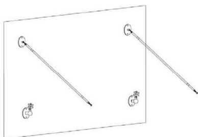
Die Zugstangen werden nun in die oberen Wandhalter eingehängt, und mit Bolzen fixiert. Die Bolzen werden mit Sicherungsringen gesichert.
