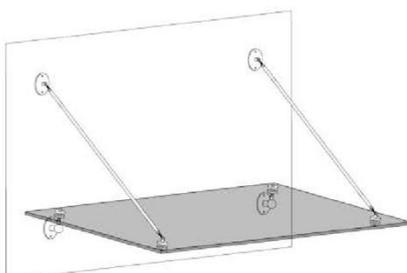
Die Scheibe wird mit den vorderen Punkthaltern an den Zugstangen eingehängt und mit Bolzen fixiert. Die Bolzen werden mit Sicherungsringen gesichert. Durch drehen der Zugstange kann das Dach ausgerichtet und justiert werden. Dabei ist auf eine ausreichende Einschraubtiefe der Anschlusssteile an der Zugstange zu achten (Mindest-Einschraubtiefe = 10mm). Die Anschlusssteile werden danach mit den Kontermuttern gegen ein weiteres verdrehen der Zugstange gesichert.
