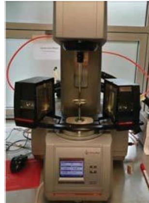
Abb. A 4.1: Versuchsaufbau, Rheometer
