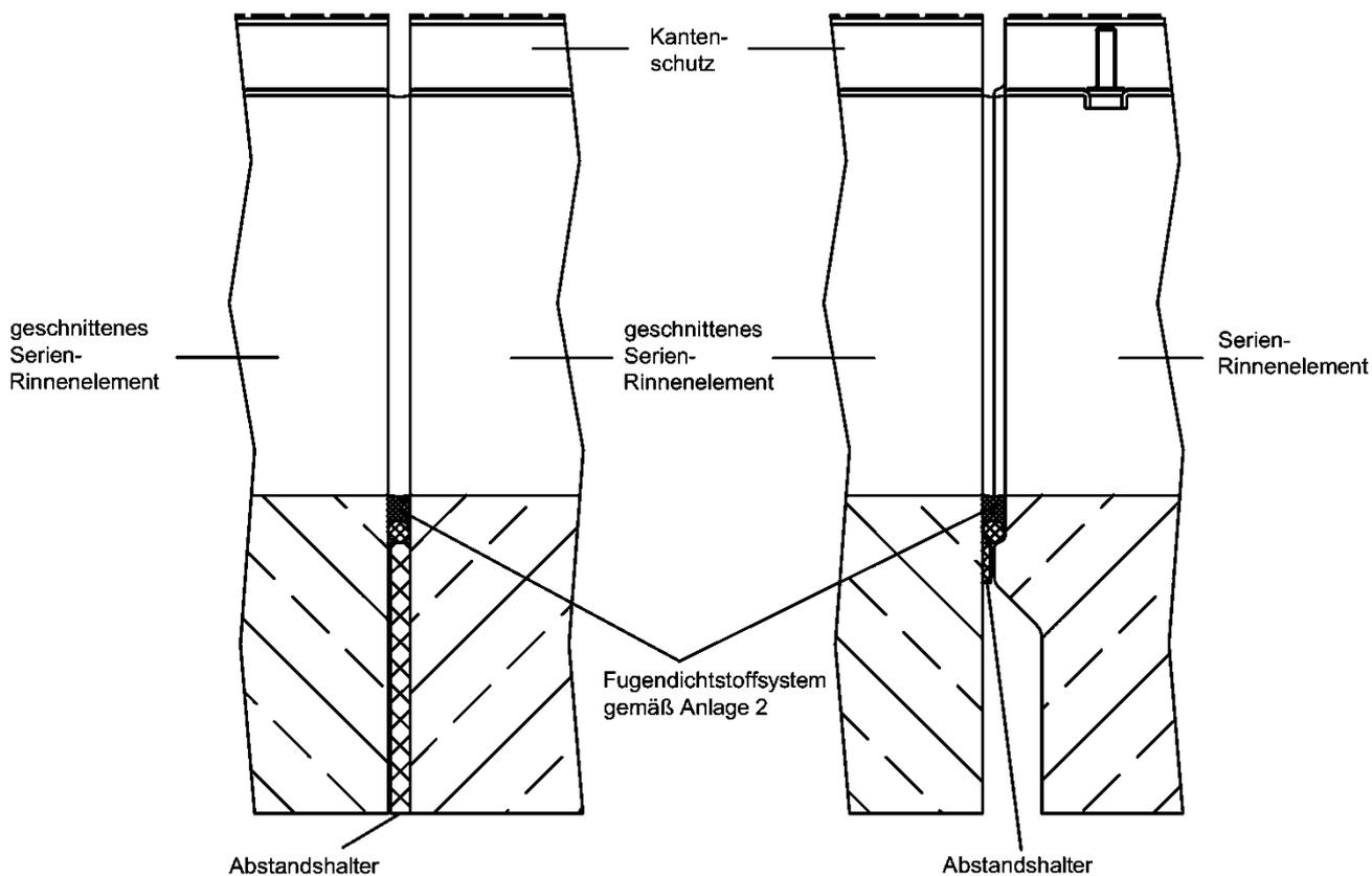
BIRCOmassiv Kastenrinnensystem für die Verwendung in LAU-Anlagen
