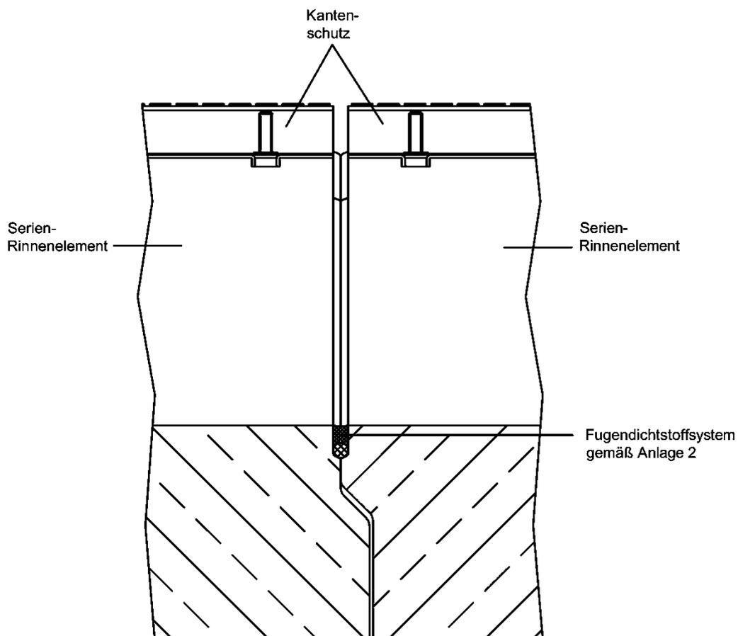
BIRCOmassiv Kastenrinnensystem für die Verwendung in LAU-Anlagen
