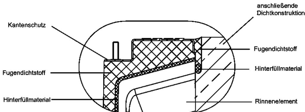
**Fugenausbildung** zwischen den Rinnenfertigteilen und zwischen der anschließenden Dichtkonstruktion und den Rinnenfertigteilen
