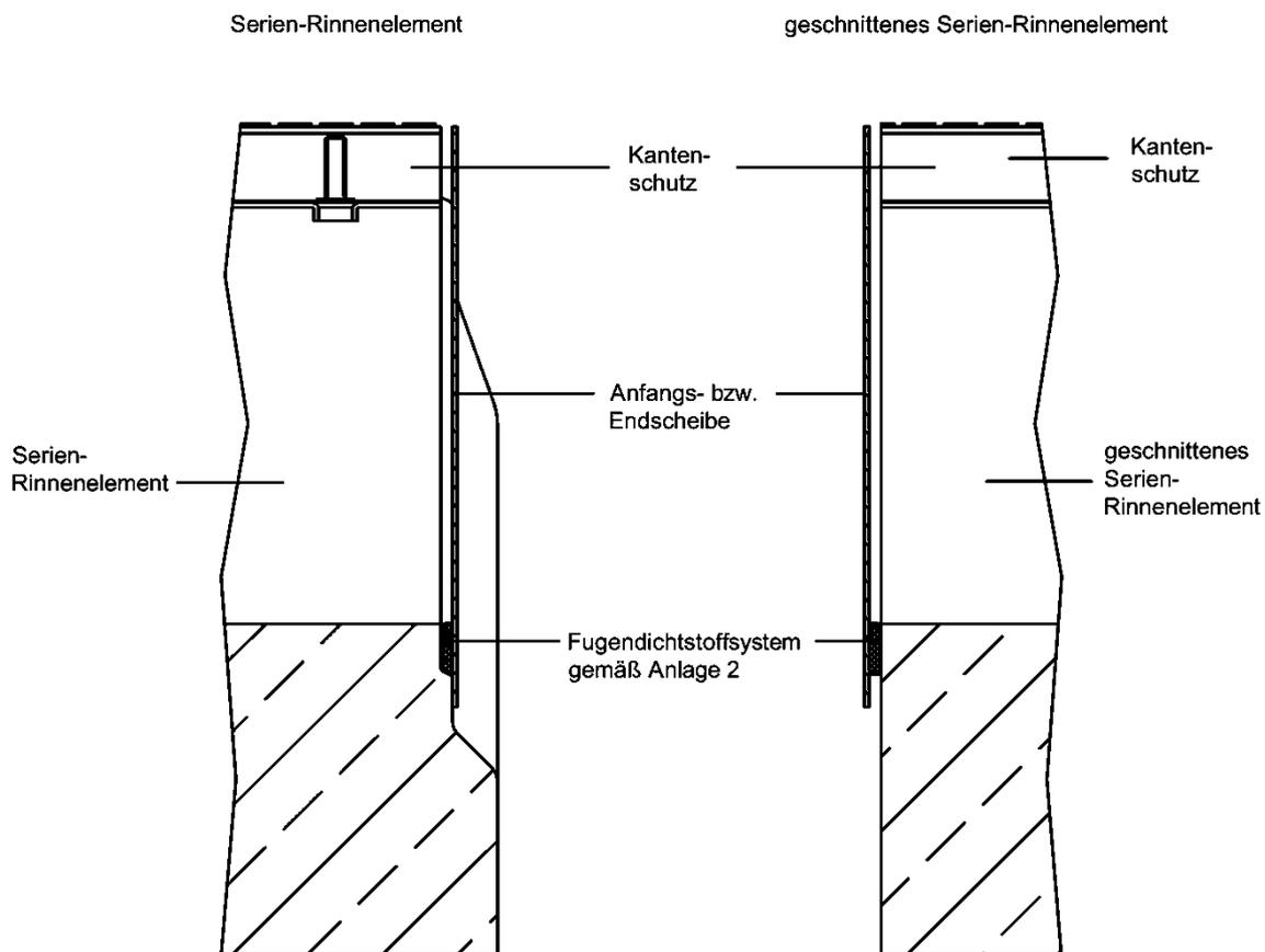
BIRCOmassiv Kastenrinnensystem für die Verwendung in LAU-Anlagen
