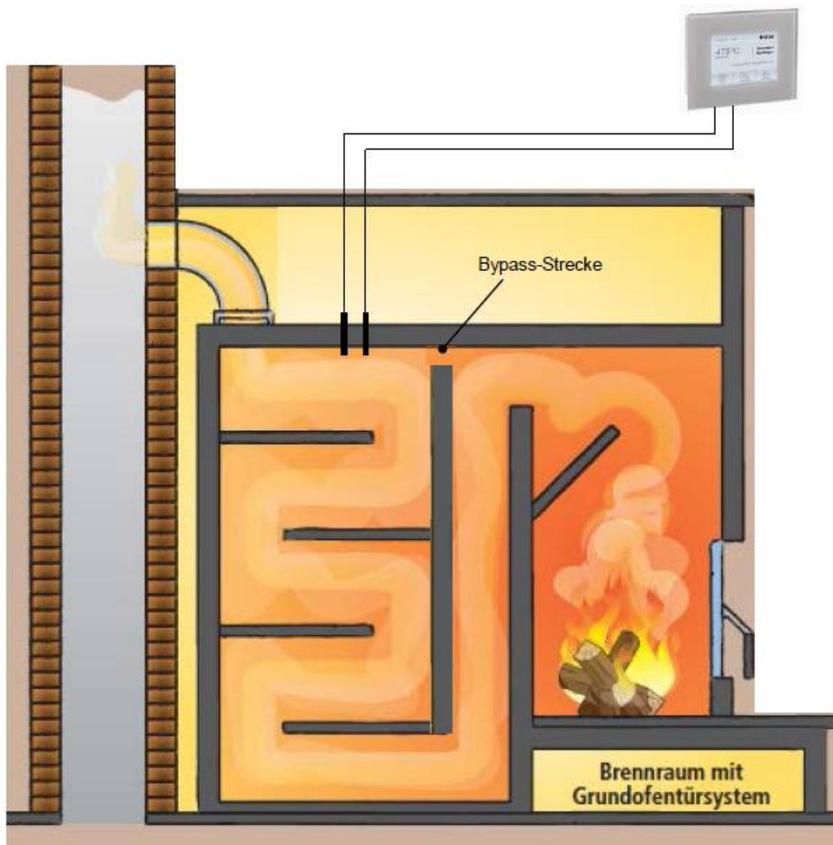
LEDA Unterdruck-Controller LUC2 - Eigenständige Sicherheitseinrichtung zur Gewährleistung eines gefahrlosen gemeinsamen Betriebes von Lüftungsanlagen und raumluftabhängigen Feuerstätten
