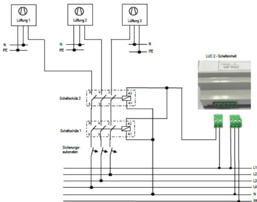
LEDA Unterdruck-Controller LUC2 - Eigenständige Sicherheitseinrichtung zur Gewährleistung eines gefahrlosen gemeinsamen Betriebes von Lüftungsanlagen und raumluftabhängigen Feuerstätten
