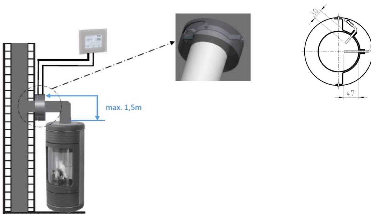
LEDA Unterdruck-Controller LUC2 - Eigenständige Sicherheitseinrichtung zur Gewährleistung eines gefahrlosen gemeinsamen Betriebes von Lüftungsanlagen und raumluftabhängigen Feuerstätten
