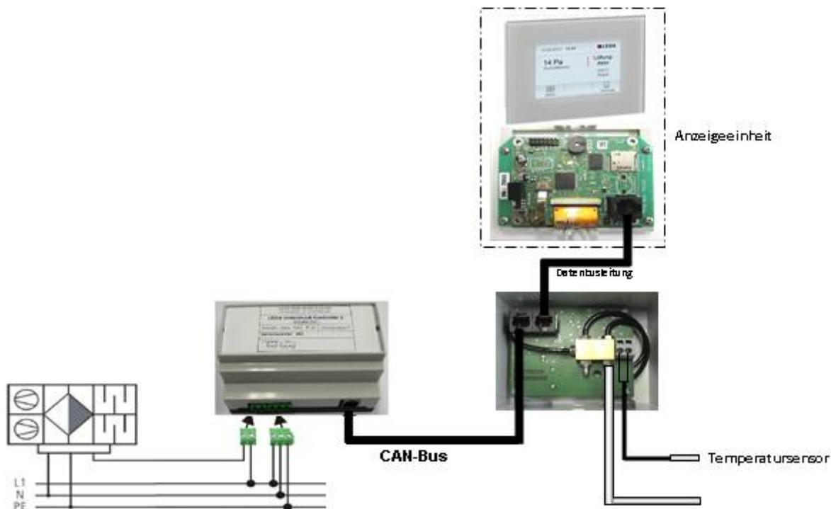
LEDA Unterdruck-Controller LUC2 - Eigenständige Sicherheitseinrichtung zur Gewährleistung eines gefahrlosen gemeinsamen Betriebes von Lüftungsanlagen und raumluftabhängigen Feuerstätten
