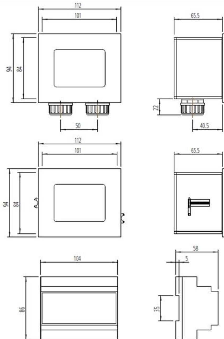
LEDA Unterdruck-Controller LUC2 - Eigenständige Sicherheitseinrichtung zur Gewährleistung eines gefahrlosen gemeinsamen Betriebes von Lüftungsanlagen und raumluftabhängigen Feuerstätten
