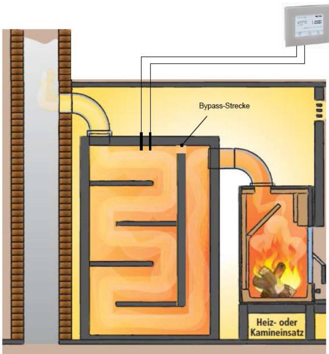
LEDA Unterdruck-Controller LUC2 - Eigenständige Sicherheitseinrichtung zur Gewährleistung eines gefahrlosen gemeinsamen Betriebes von Lüftungsanlagen und raumluftabhängigen Feuerstätten
