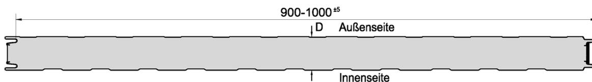
$t_{nom1}$ : Nennblechdicke, äußere Deckschicht  $t_{nom1}$ : 0,50 ; 0,63 ; 0,75 ; 0,88 ; 1,00 mm
