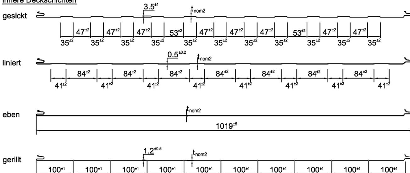
Tragende Sandwichelemente "Ondatherm-", "Pflaum-" und "Promisol-" "AM03" mit einer PUR-Kernschicht zwischen Stahldeckschichten; für Außenwand- und Dachkonstruktionen
