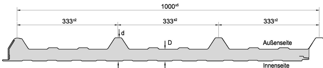
$t_{nom1}$ : Nennblechdicke, äußere Deckschicht  $t_{nom1}$ : 0,50 ; 0,63 ; 0,75 ; 0,88 ; 1,00 mm
