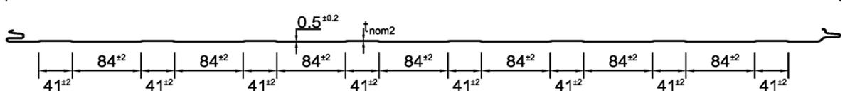
Tragende Sandwichelemente "Ondatherm-", "Pflaum-" und "Promisol-" "AM03" mit einer PUR-Kernschicht zwischen Stahldeckschichten; für Außenwand- und Dachkonstruktionen
