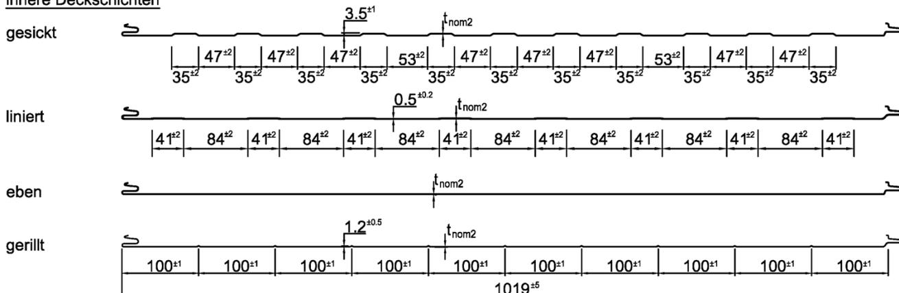
Tragende Sandwichelemente "Ondatherm-", "Pflaum-" und "Promisol-" "AM03" mit einer PUR-Kernschicht zwischen Stahldeckschichten; für Außenwand- und Dachkonstruktionen
