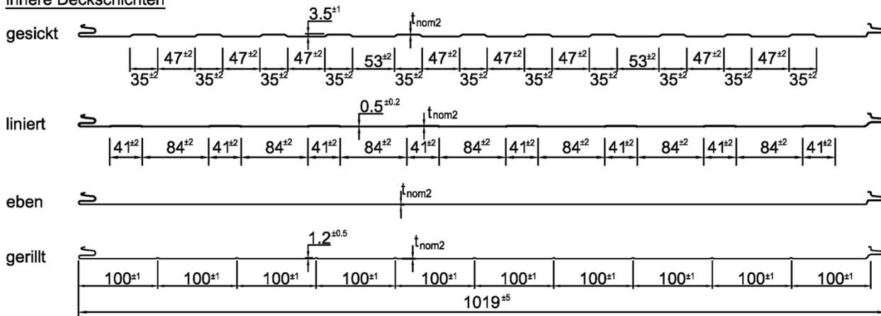
Tragende Sandwichelemente "Ondatherm-", "Pflaum-" und "Promisol-" "AM03" mit einer PUR-Kernschicht zwischen Stahldeckschichten; für Außenwand- und Dachkonstruktionen
