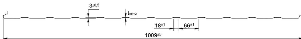
Tragende Sandwichelemente "Maukatherm T IQ+" mit einer PUR-Kernschicht zwischen zwei Stahldeckschichten; für Dachkonstruktionen
